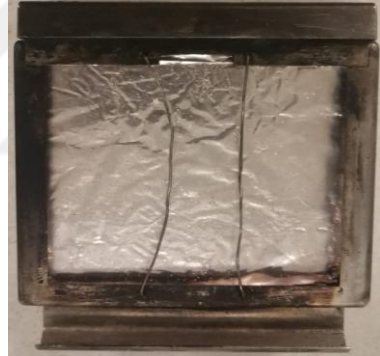
Görsel 5.13. Duman yoğunluğu test numunesi
