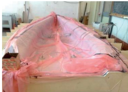
Görsel 2.6. Vakum infüzyon yöntemiyle üretilmiş tekne gövdesi [52]
