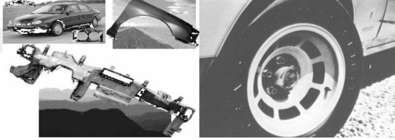
Görsel 2.5. Basınçla kalıplama yöntemiyle üretilmiş GFRP kompozit tamponlar ve teker üstleri [49-50]
