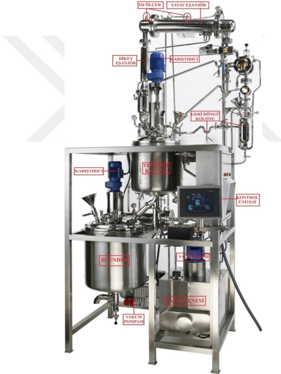
Görsel 5.1. 20 kg kapasiteli paslanmaz çelik pilot reaktör sistemi [128]
