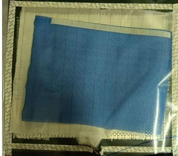
Grsel 5.5. Pleksi levhanın infzyon naylonu ile kaplanması
