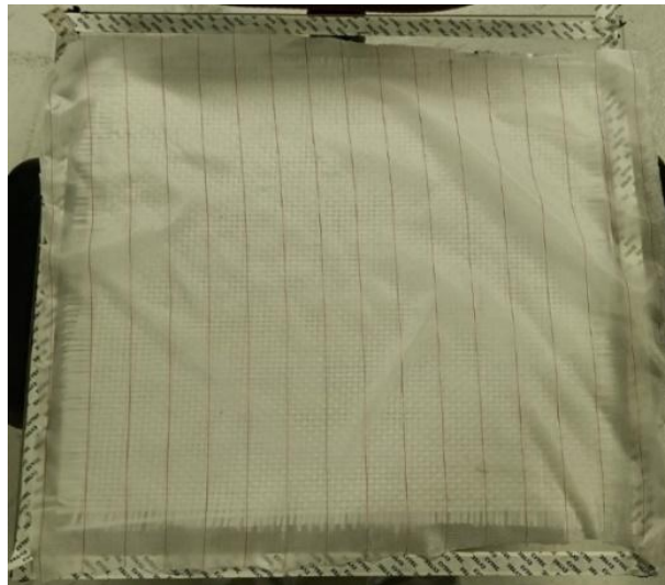
Görsel 5.3. Cam elyaf kumaşların soyma kumaşı ile örtülmesi
