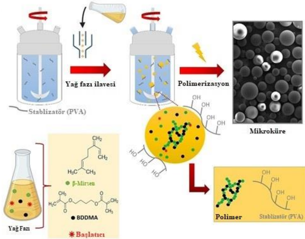
Şekil 5.1. My'in süspansiyon kopolimerizasyon yönteminin şematik gösterimi [102]
