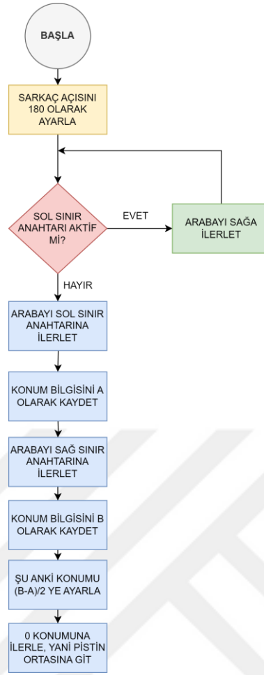
Şekil 4.26. Merkeze Dönüş (Homing) Kontrol Döngüsü
