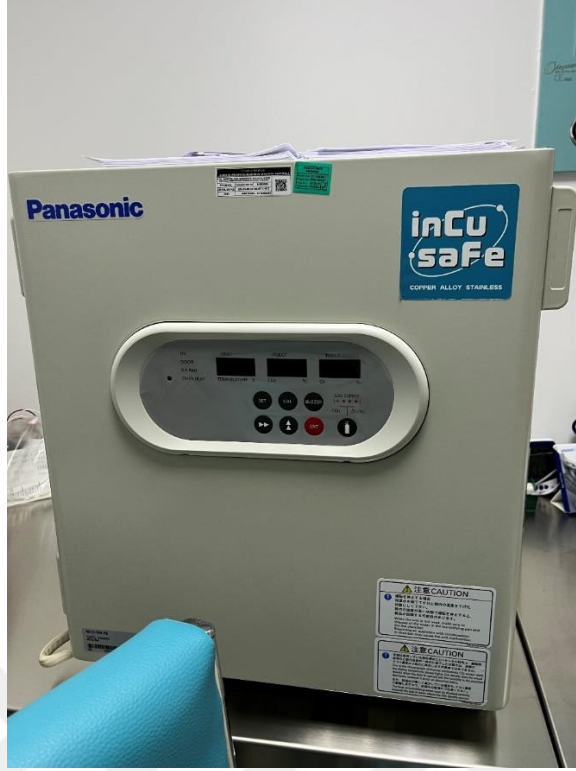
Resim 3.5. Korbondiyoksit kontrollü inkübatör (IncuSafe Multigas Incubators, Model MCO-5M-PE)
