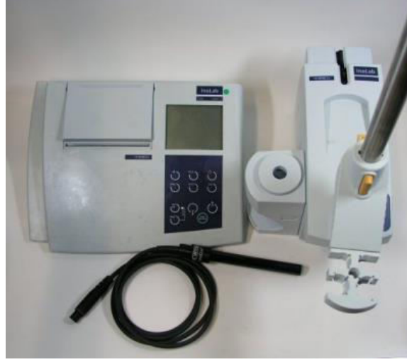
Şekil 3.8. WTW marka Cond Level 3 modülü kontrol terminali.
