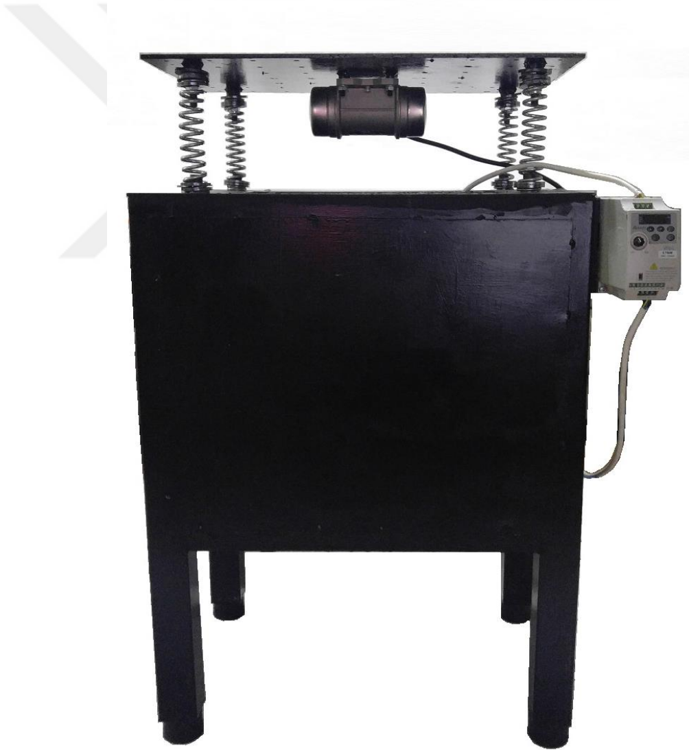
Şekil 3.8. Tez çalışması kapsamında geliştirilen titreşimli kalıplama makinesi.
