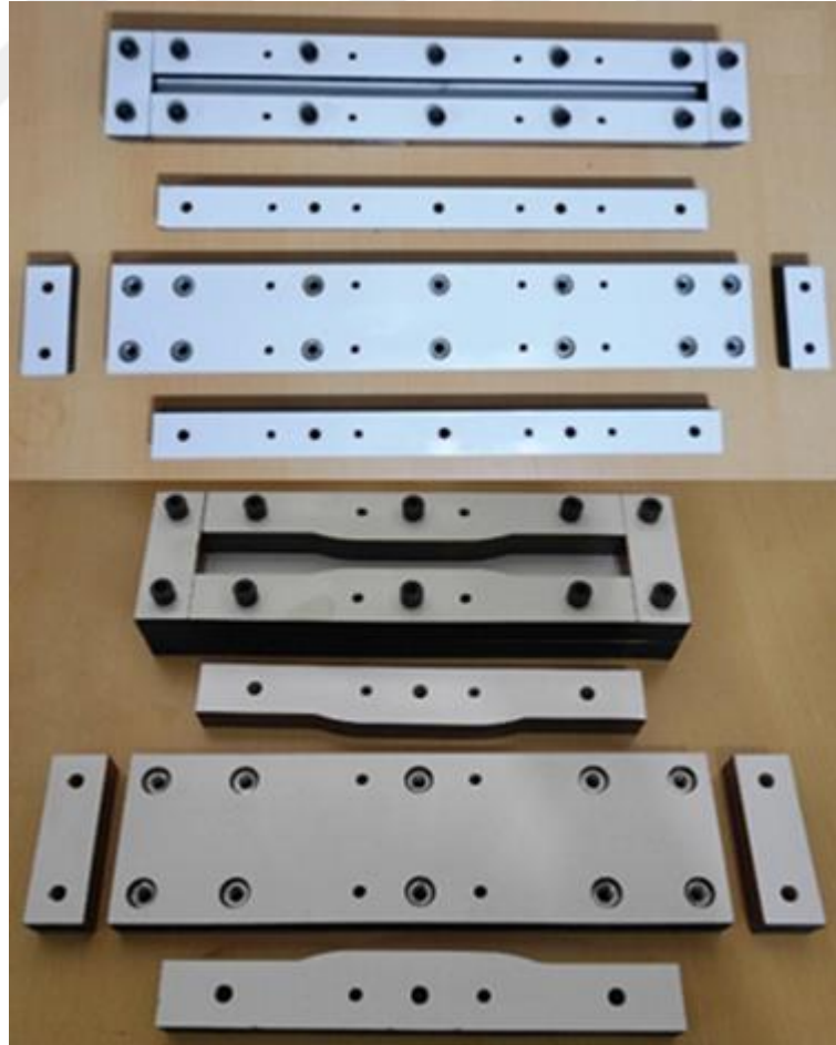
Şekil 3.7. Mdf malzemeden üretilen titreşim testi ve çekme testi numune kalıpları
