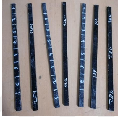
Şekil 4.8. Titreşim sönümleme testi numune örnekleri
