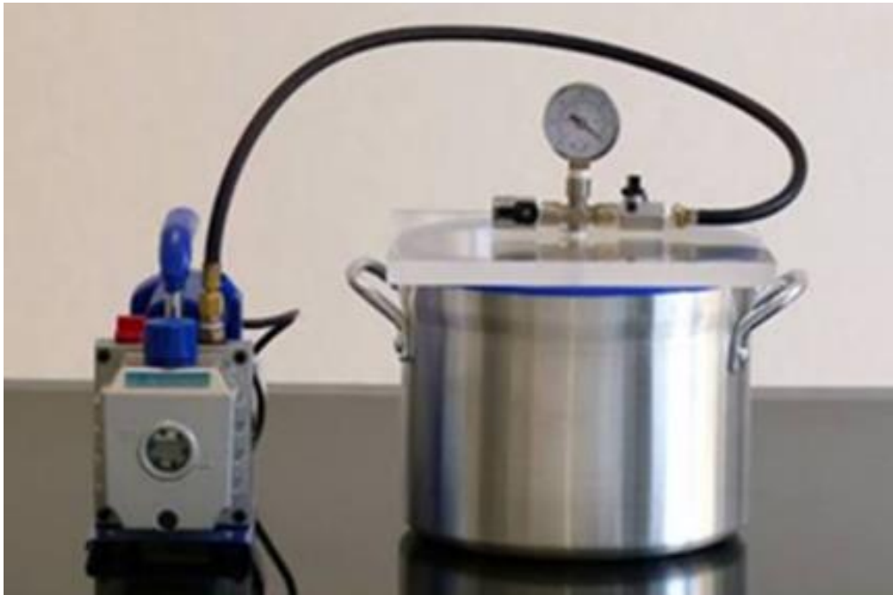
Şekil 3.5. Vakum pompası ve baloncuk arındırma haznesi
