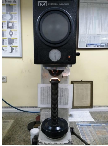
Şekil 4.22. Sertlik test cihazı ve test numunesi
