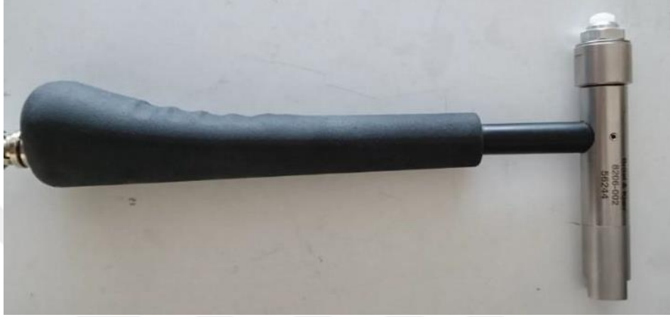
Şekil 4.10. Brüel&Kjaer Type 8206-002 model darbe çekici
