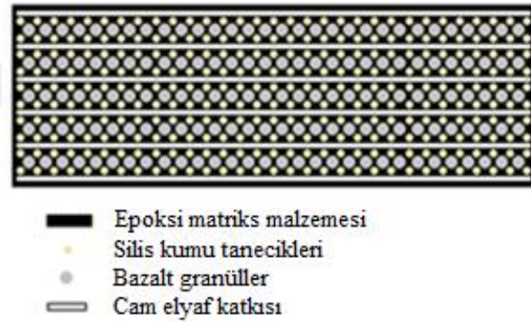
Şekil 3.11. Cam elyaf katkılı ideal kompozit yapısı
