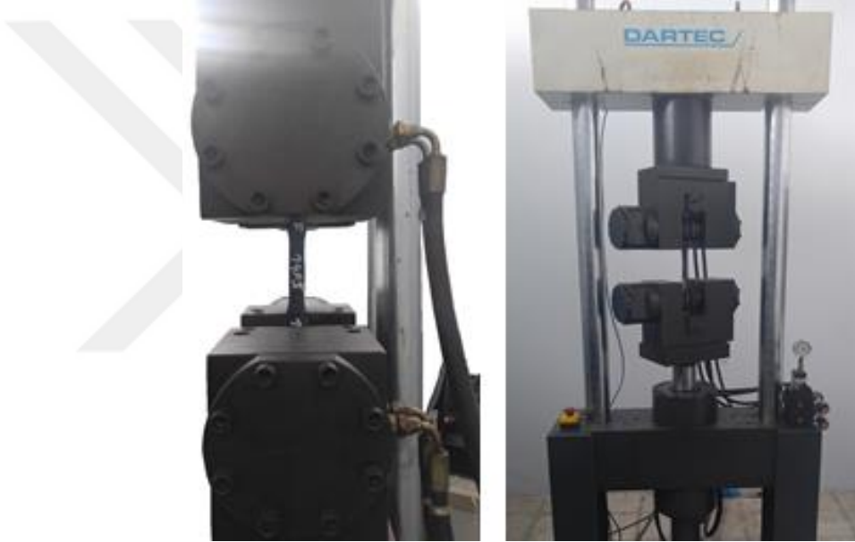
Şekil 4.1. Çekme cihazı ve çekme testi numunesi
