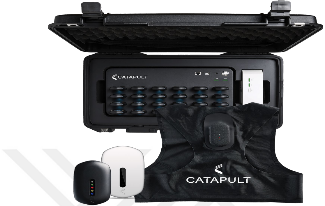
Şekil 1. Catapult S7 Vector cihazı, yeleşi ve ünitesi (Catapult, 2023)
