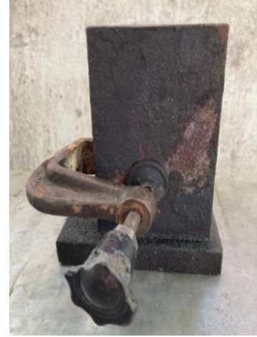
Şekil 8.4: Günümüzde Kullanılan Astar Kalıbı.
