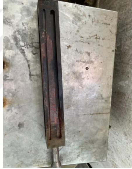
Şekil 8.2: Günümüzde Kullanılan Çubuk Kalıbı (Direzik).
