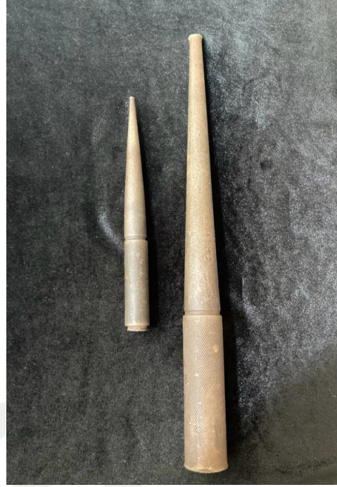
Şekil 8.28: Günümüzde Kullanılan Küçük Ve Büyük Malafalar.
