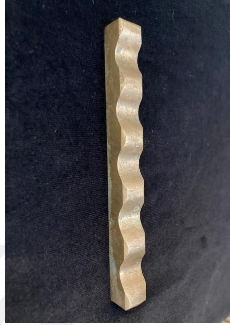
Şekil 8.24: Günümüzde Kullanılan Pirinçten Yapılmış Şekillendirme Aparatı.
