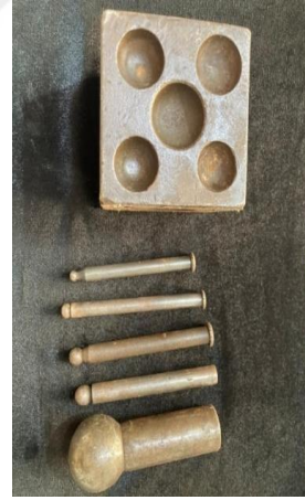
Şekil 8.18: Günümüzde Kullanılan Heşteek Seti.
