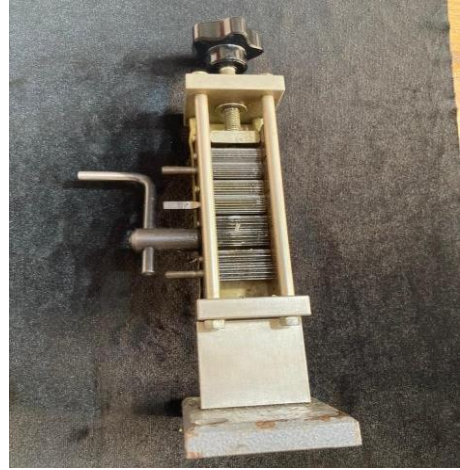
Şekil 8.14: Günümüzde Kullanılan Tırtır (Zikzak) Makinesi.
