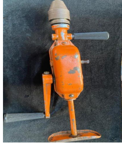
Şekil 8.16: Günümüzde Kullanılan Teliman (El Gırgırı).
