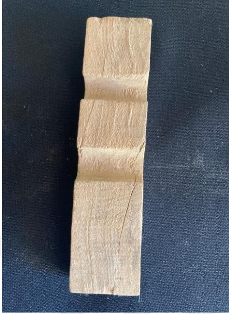
Şekil 8.23: Geçmişte Kullanılan Tahtadan Yapılmış Şekillendirme Aparatı.
