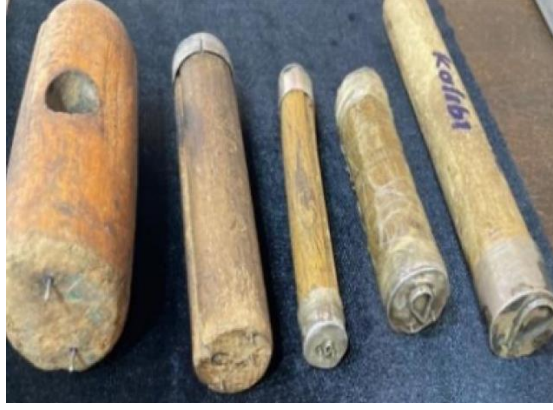
Şekil 8.30: Günümüzde Kullanılan Tel Şekillendirme Aparatı.
