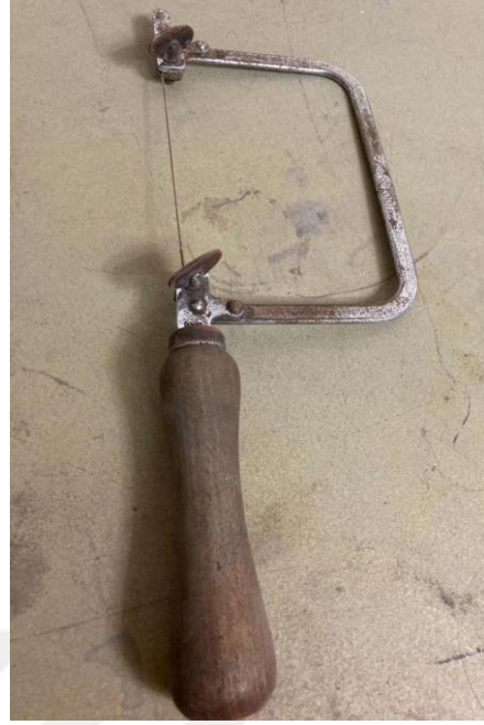
Şekil 8.20: Günümüzde Kullanılan Kıl Testeresi.
