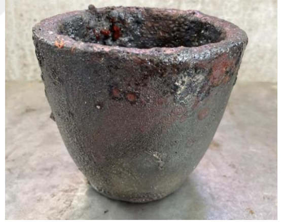
Şekil 8.10: Günümüzde Kullanılan Gümüş Eritme Potası.
