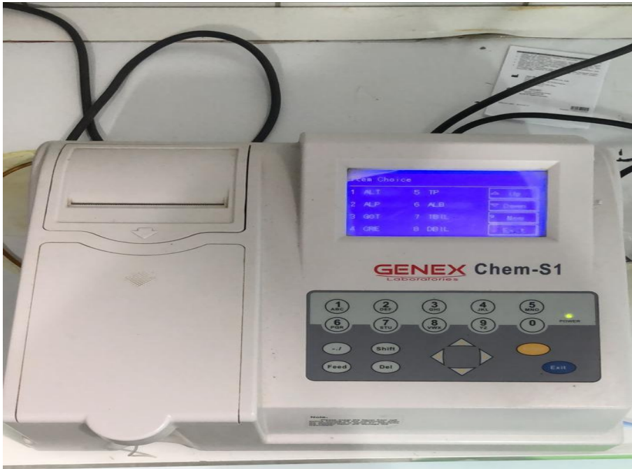
Şekil 3.3. Klinik kimya analizleri yapmak için spektroskopi cihazı
