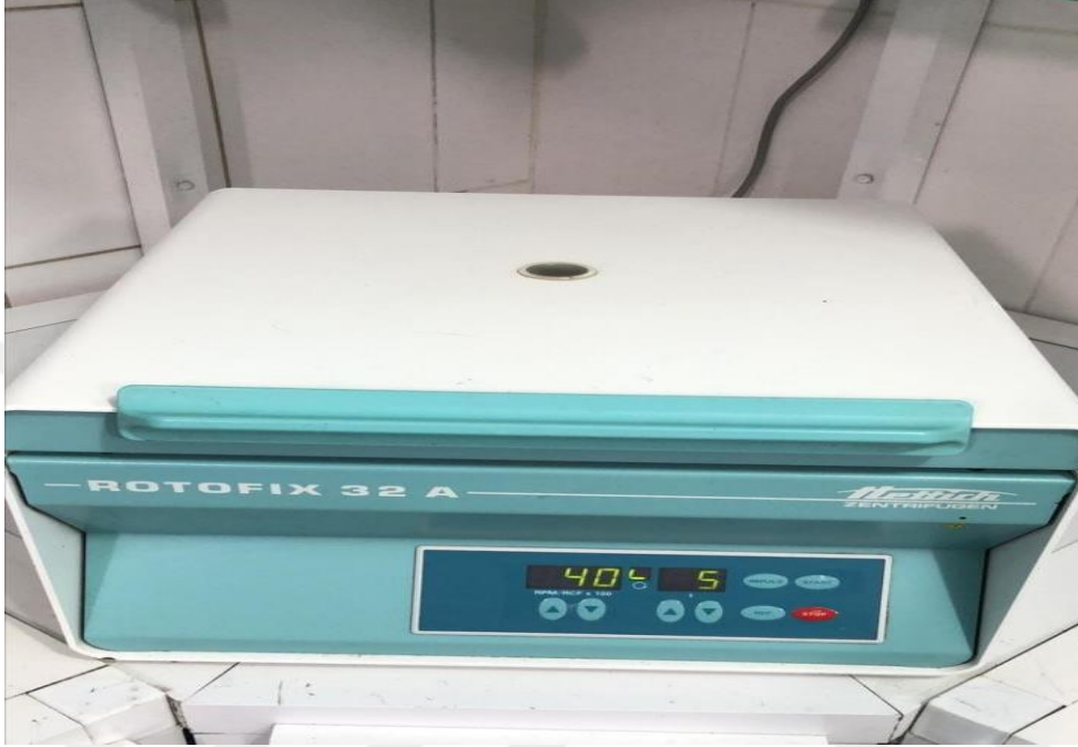
Şekil 3.1. Kan bileşenlerini ayırmak için kullanılan santrifüj cihazı
