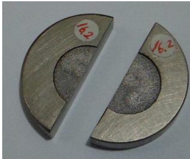
Resim 3.3. EEİ İşlenmiş Ti-6Al-4V alaşımı
