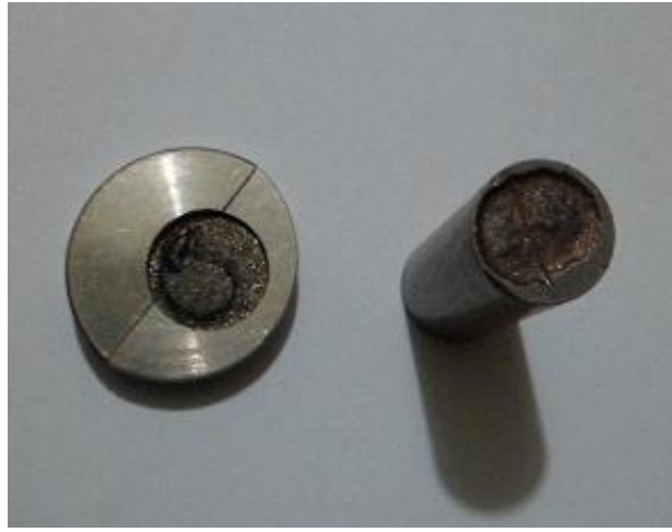
Resim 4.1. Yetersiz t_p sonucu oluşan işparçası ve elektrot tahrifatları
