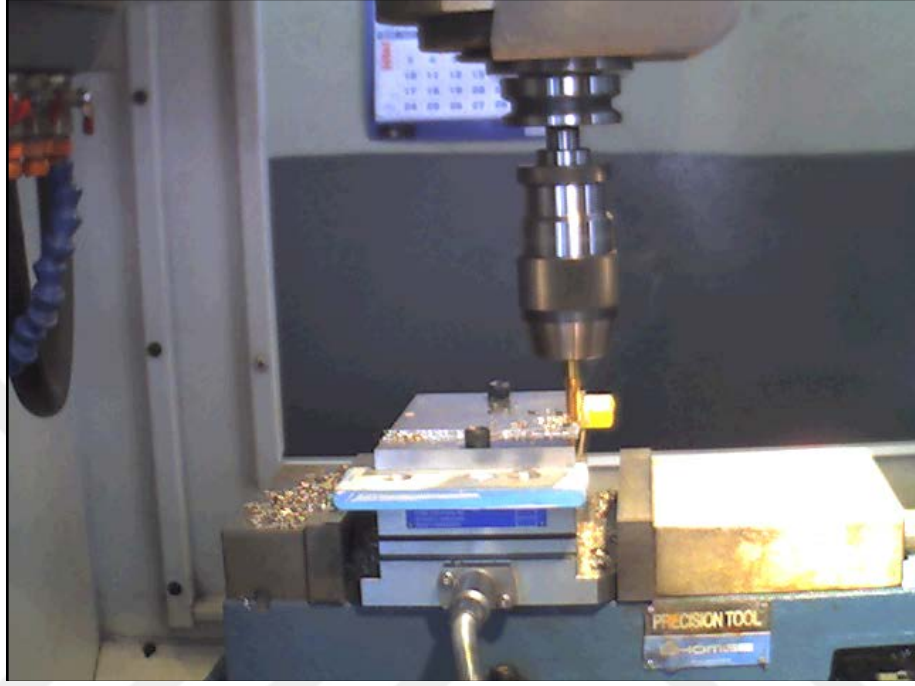
Şekil 3.5. TiN kaplı HSS freze çakısıyla açılan 2. freze kanalı
