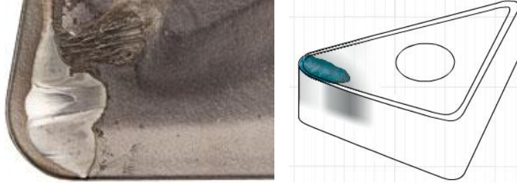
Resim 2.3 Krater aşınması (İnt.Kyn.3, İnt.Kyn.4).
