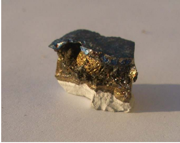
Resim 4.5. %99'luk Ar gazı beslenerek inert hale getirilmiş fırında 1600°C'de 2 saat süre bekletilen alaşım üzerindeki oksit tabakası
