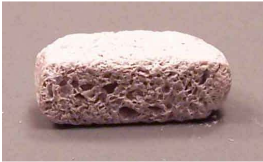
Resim 3.4. Gözenekli yapı haline getirilmiş pellet
