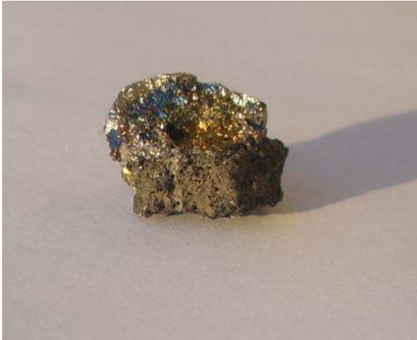
Resim 4.2. 1600^{\circ}\text{C} de normal atmosferde oluşan oksitlenmiş malzeme
