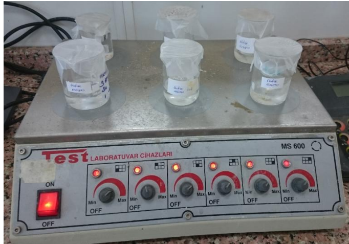
Resim 3.2 Çözeltiler için kullanılan KERN EW 420-3NM model hassas terazi ve TEST MS 600 model manyetik karıştırıcı.
