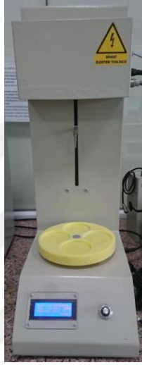
Resim 3.5 Kaplamada kullanılan daldırma kaplama cihazı.
