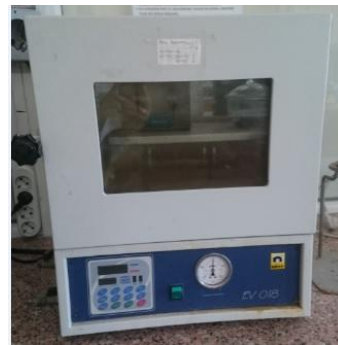
Resim 3.6 UV kürlemede kullanılan UV kurutma cihazı ve termal kürlemede kullanılan nüve EV018 vakumlu etüv.
