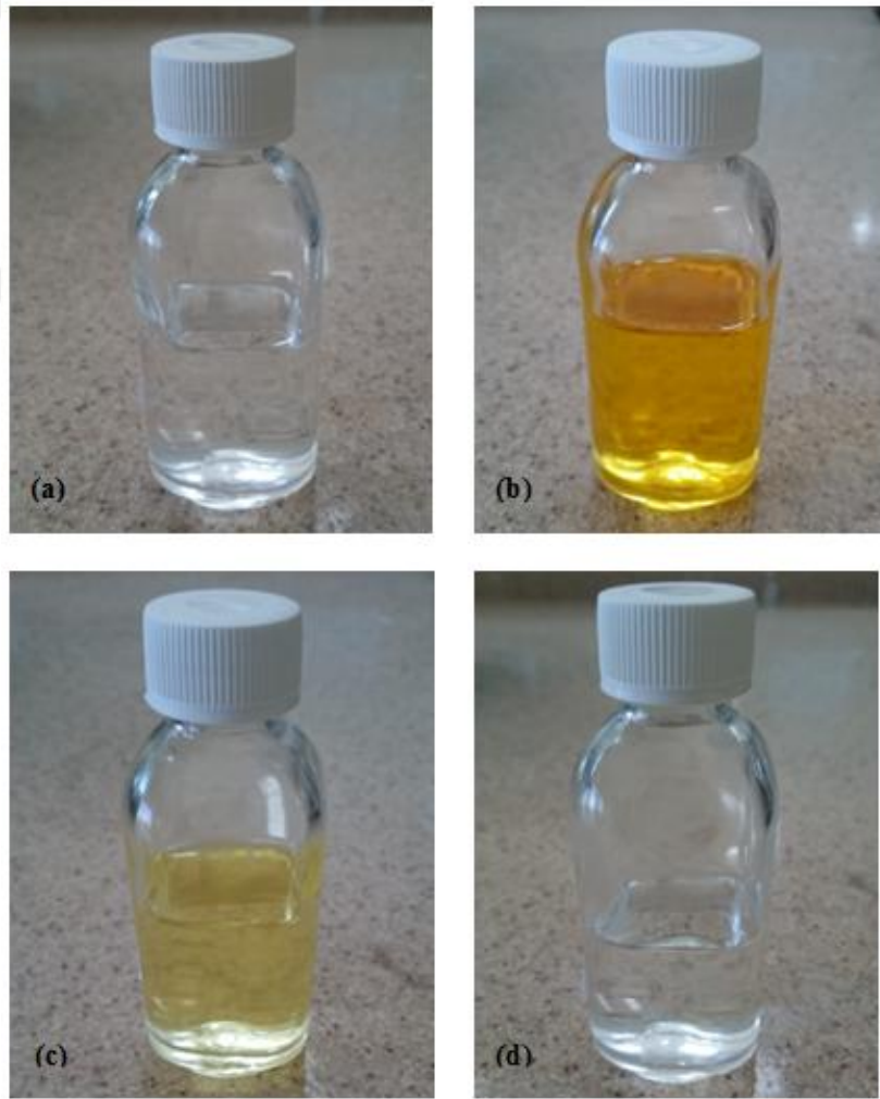
Resim 3.4 GLYMO kullanılarak hazırlanan (a)saf (b)titanyum alkoksit (c)zirkonyum alkoksit ve (d)bor alkoksit katkılı hibrit soler.
