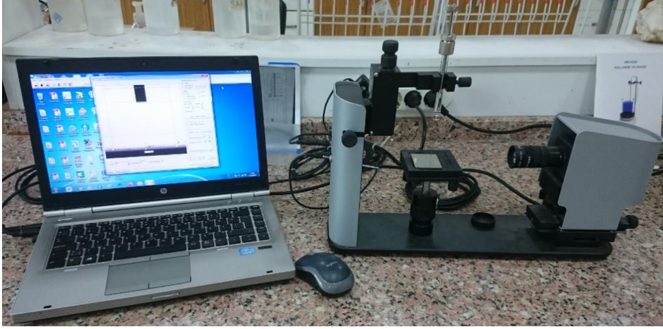
Resim 3.12 KSV Attension ThetaLite TL 101 Optical Tensiometre temas açısı ölçüm cihazı.
