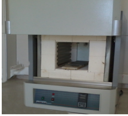
Şekil 5.1 Yaşlandırma işleminin uygulandığı rezistanslı fırın.
