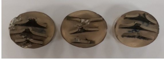
Şekil 5.9 Hasarlı bölgenin kalıba alınmış hali.
