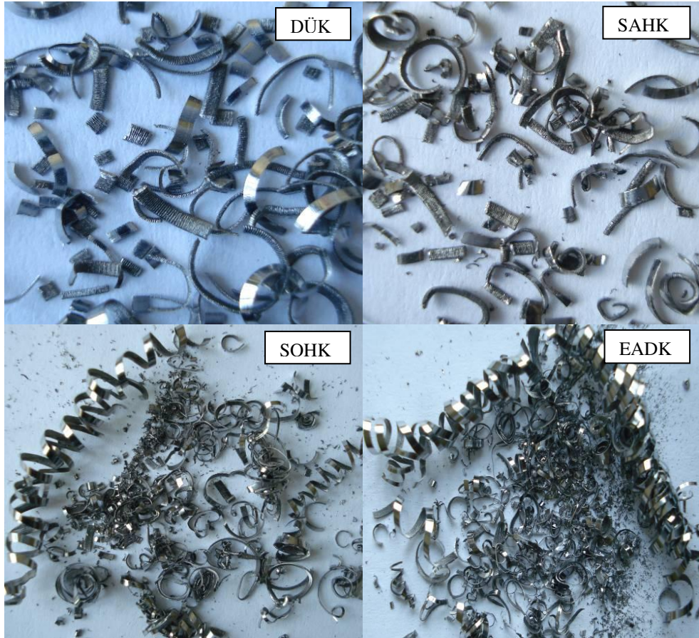
Resim 6.1. 2 m/dak kesme hızında DÜK, SAHK, SOHK ve EADK kesicilerin kaplamsız takım ile kuru kesme şartı altındaki talaş resimleri
