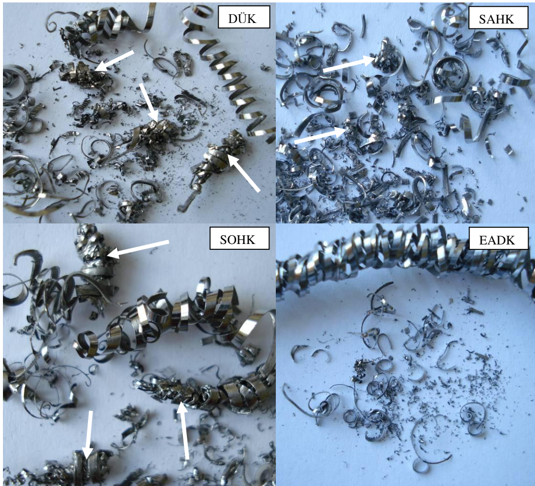
Resim 6.7. 4 m/dak kesme hızında DÜK, SAHK, SOHK ve EADK kesicilerin kaplamalı takım ile kuru kesme şartı altındaki talaş resimleri
