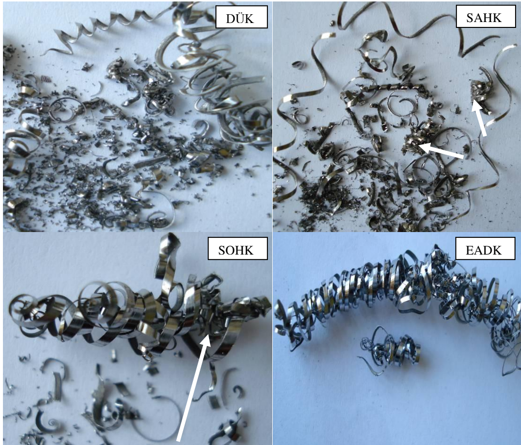
Resim 6.8. 5 m/dak kesme hızında DÜK, SAHK, SOHK ve EADK kesicilerin kaplamalı takım ile kuru kesme şartı altındaki talaş resimleri
