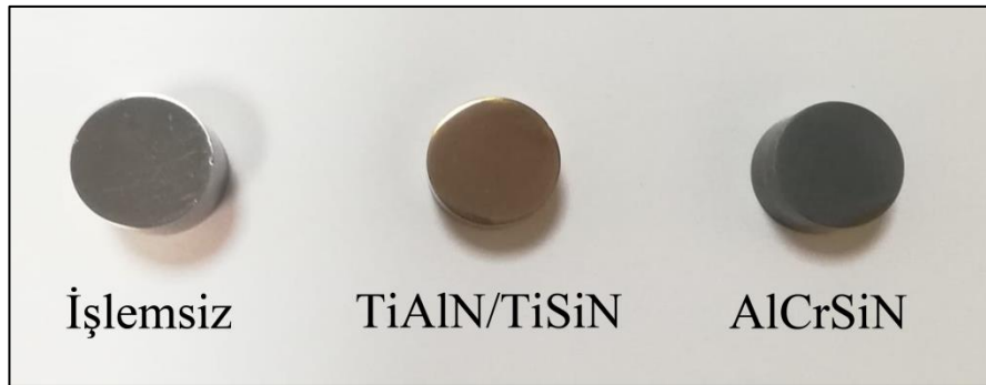
Şekil 3.1. Silindirik test numuneleri
