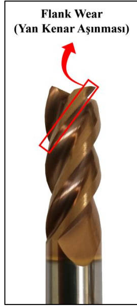
Şekil 3.5. Kesici takımdaki yan kenar aşınma bölgesi
