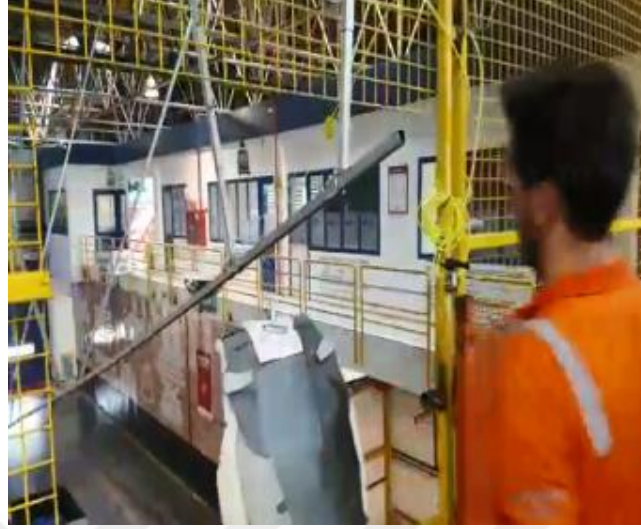
Şekil 4.1. Sıralaması yapılan kılıf ve süngerin rayla montaj hattına gönderilmesi
