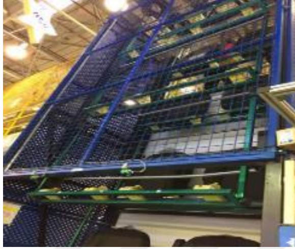
Şekil 4.9. Sırt ünitelerini taşıyan asansör
