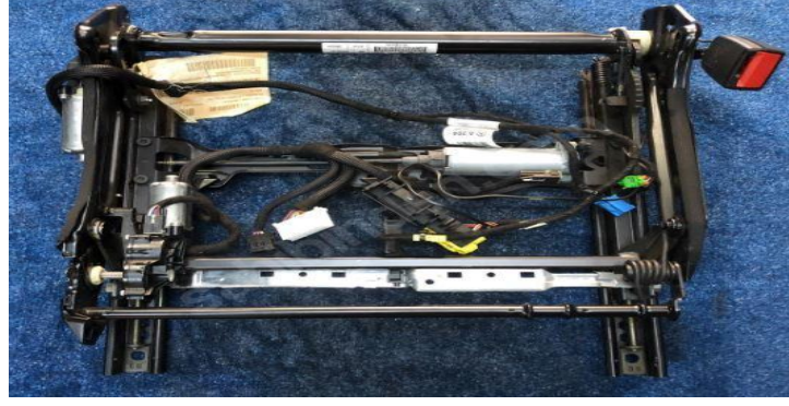
Şekil 3.2: Araç koltuk şasi tasarımı (numune ürün)
