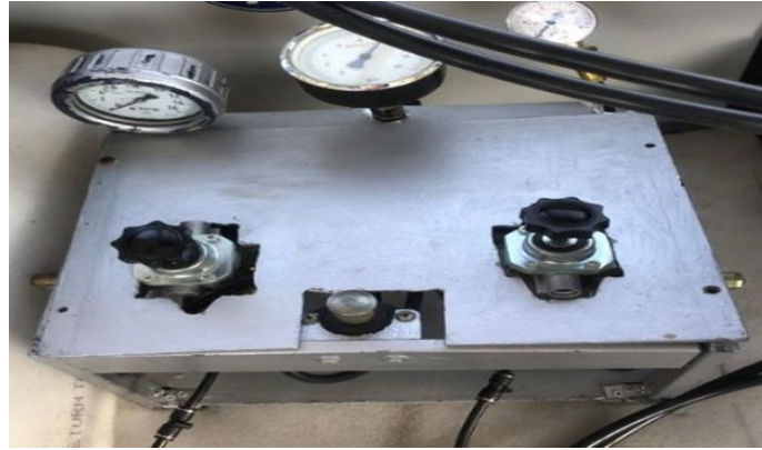
Resim 3.7 Kabin içerisinde dingillere istenilen basınçlarda fren yaptırmaya düzeneği.
