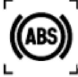
Şekil 2.1 ABS uyarı sinyali (BM/AEK R121 Motorlu Araçların El Kontrolleri İkaz ve Göstergelerinin Yeri ve Tanımlanması Konusunda Tip Onayı Yönetmeliği,18.01.2006)
