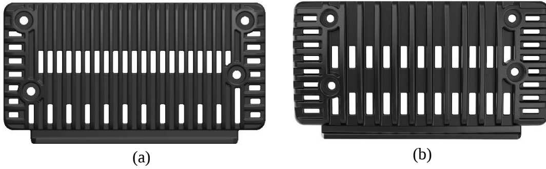
Şekil 5.19. Optimal yan kapakların tasarımı (a) Analizleri yapılan yan kapak (b) Geliştirilmiş yan kapak
