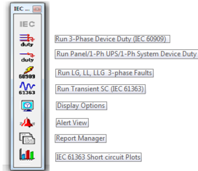
Şekil 4.16: ETAP IEC kısa devre analizinin çalıştırılması.
