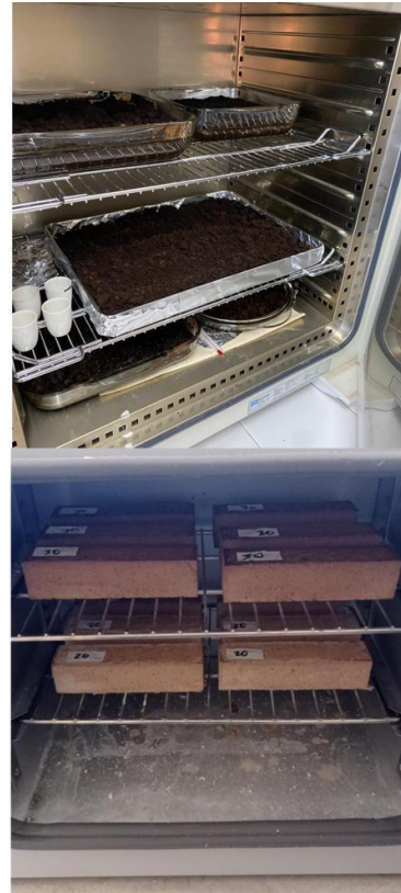
Şekil 3.6. Ultrases ön işlemlili kahve atığının ve numunelerin kurutulmasında kullanılan etüv
