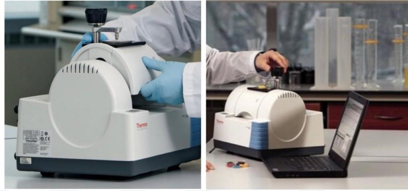
Şekil 3.10. FTIR spektrometre cihazında örnek analiz yöntemi
