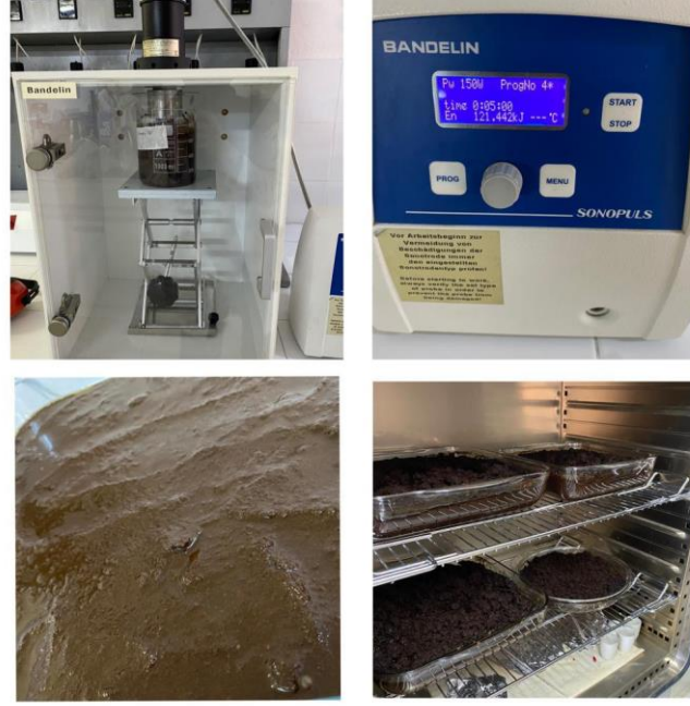
Şekil 3.16. Kahve atığının ultrases ön işlemi
