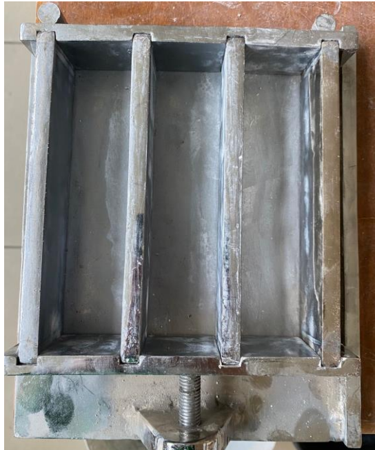
Şekil 3.4. Çalışmada kullanılan demir kalıplar
