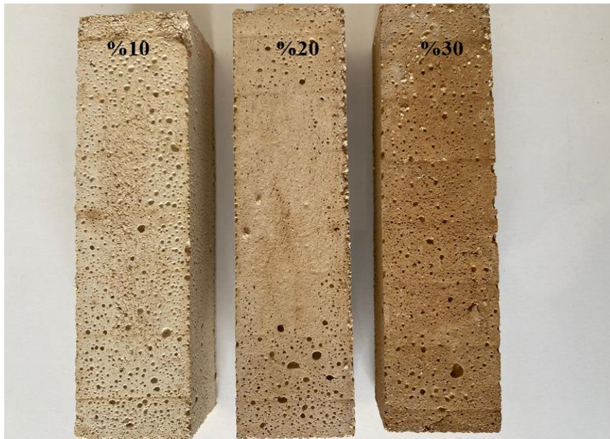
Şekil 3.19. %10, %20 ve %30 oranlarında üretilen ham kahve atığı katkılı yalıtım sıvası numuneleri (4×4×16 cm)
