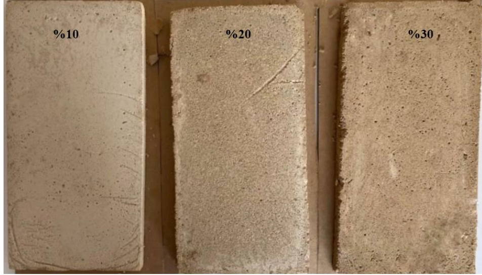
Şekil 3.20. %10, %20 ve %30 oranlarında üretilen ham kahve atığı katkılı yalıtım sıvası numuneleri (5×20×40 cm)
