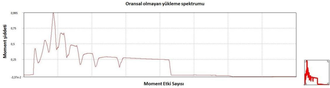
Şekil 6.10 Dişli seti yükleme sınır şartı uygulama verisi (Yavaşlatıcısız)
