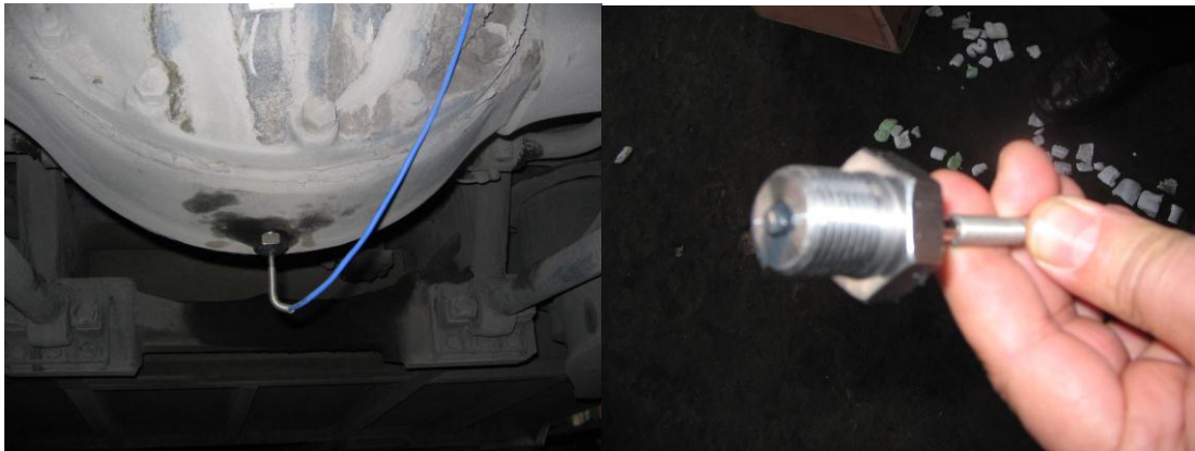
Şekil 5.8 Arka aks üzerine termocouple uygulaması
