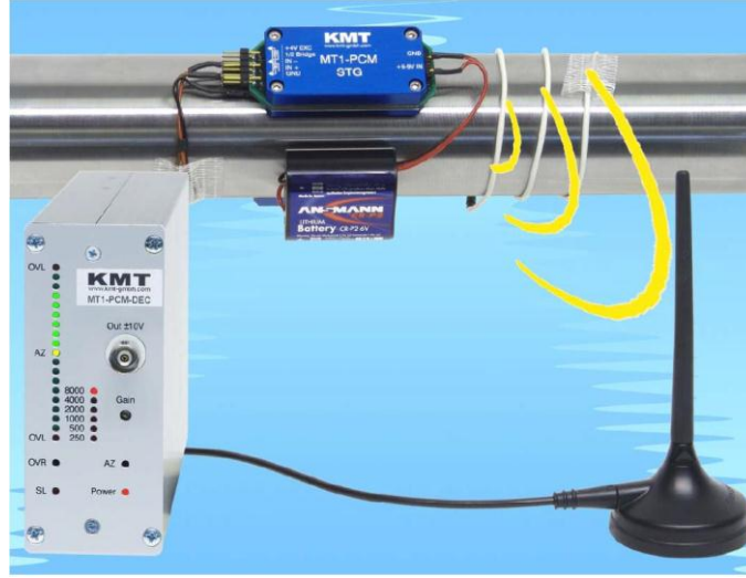
Şekil 5.7 Temassız ölçüm sistemi (telemetry) montaj şekli
