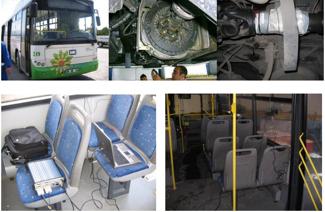
Şekil 5.11 Ölçüm esnasında sistemin taşıta uygulanması
