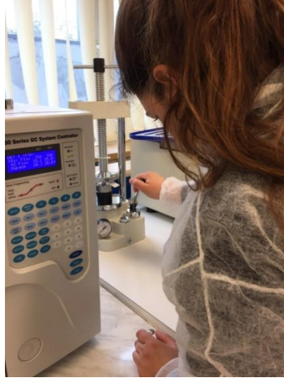
Şekil 3.15. Manuel hidrolik presle metal levhalara basınç uygulanması
