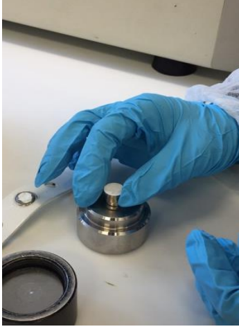
Şekil 3.15. Manuel hidrolik presle metal levhalara basınç uygulanması
