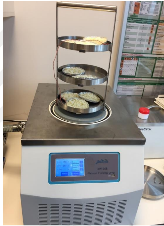
Şekil 3.11. Rendelenmiş peynir örneklerinin dondurarak kurutulması
