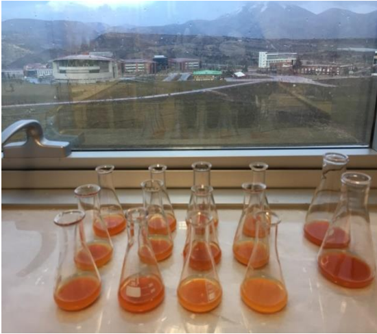
Şekil 3.7. Tuz tayininde titrasyon sırasında kalıcı kırmızı- kahverenginin görülmesi
