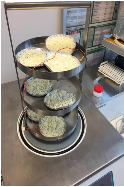
Şekil 3.11. Rendelenmiş peynir örneklerinin dondurarak kurutulması
