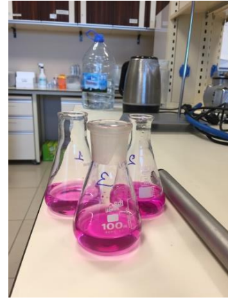
Şekil 3.5. Titrasyon yöntemiyle peynir örneklerinin toplam asitlik değerinin belirlenmesi
