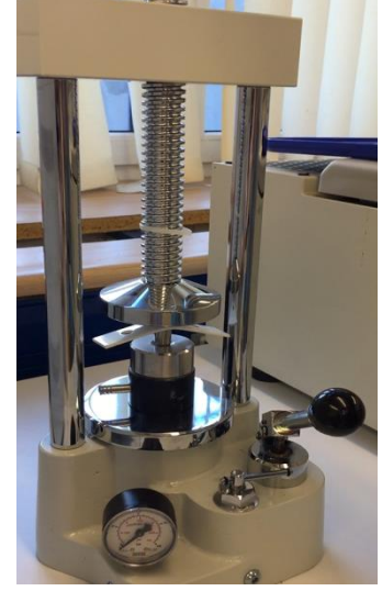
Şekil 3.15. Manuel hidrolik presle metal levhalara basınç uygulanması
