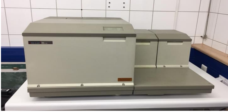
Şekil 3.17. Bu çalışmada kaşar peyniri ve eritme peyniri örneklerinin FTIR spektrumlarının alınmasında kullanılan Perkin Elmer System 2000 model FTIR spektroskopisi
