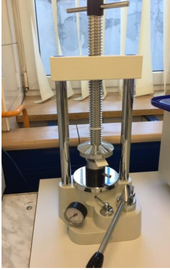
Şekil 3.15. Manuel hidrolik presle metal levhalara basınç uygulanması
