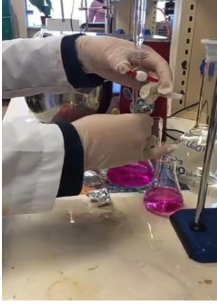
Şekil 3.5. Titrasyon yöntemiyle peynir örneklerinin toplam asitlik değerinin belirlenmesi
