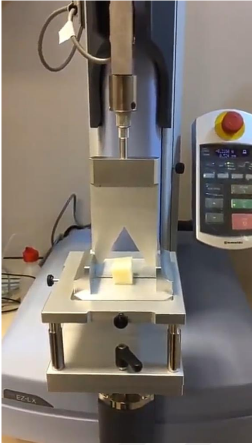
Şekil 3.10. Tekstür analizatörü ile kaşar peynirlerinin sertlik değerinin ölçülmesi
