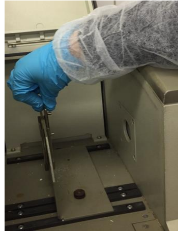
Şekil 3.16. Metal levhalar arasına preslenen pelletin çıkarılması tabya üzerine yerleştirilip cihaza takılması
