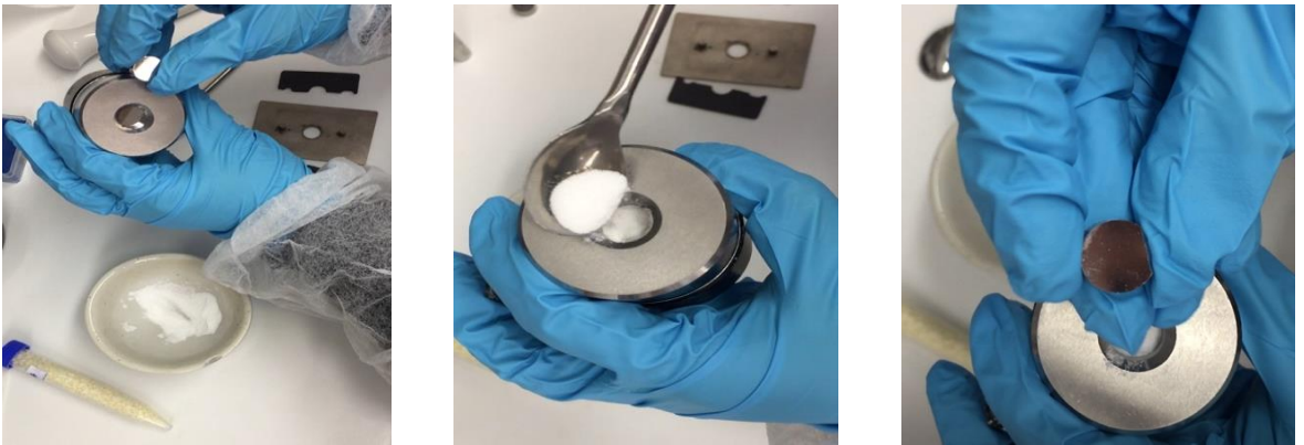
Şekil 3.14. Metal zarların metal levhaya yerleştirilmesi ve numunenin parlak yüzeyleri arasına eklenmesi
