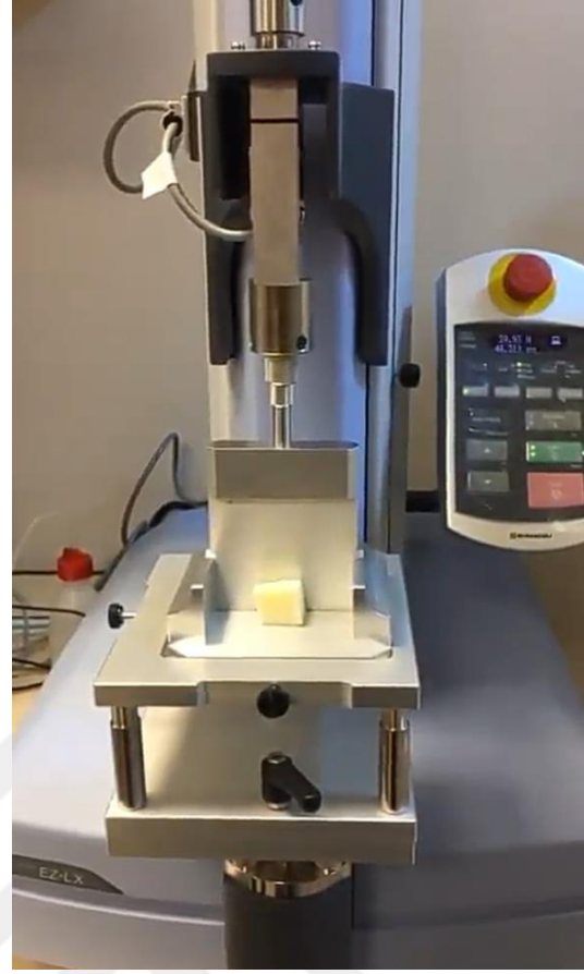
Şekil 3.10. Tekstür analizatörü ile kaşar peynirlerinin sertlik değerinin ölçülmesi
