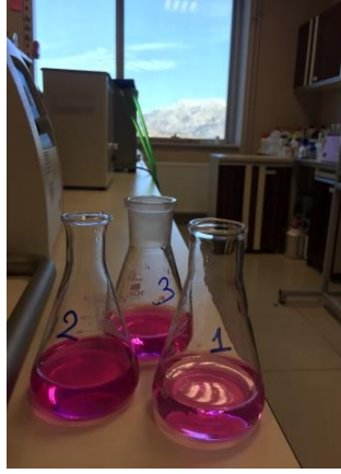
Şekil 3.5. Titrasyon yöntemiyle peynir örneklerinin toplam asitlik değerinin belirlenmesi
