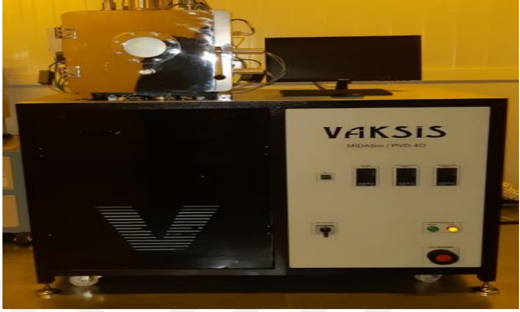
Şekil 4.1 Deneylerde Kullanılan Termal Buharlaştırma Cihazı [78].
