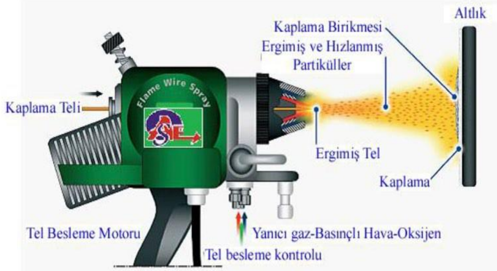
Şekil 3.9. Alev ile Püskürtme Tekniğinin Şematik Gösterimi (İnternet, Alloy Spray Engineering , 2020)
