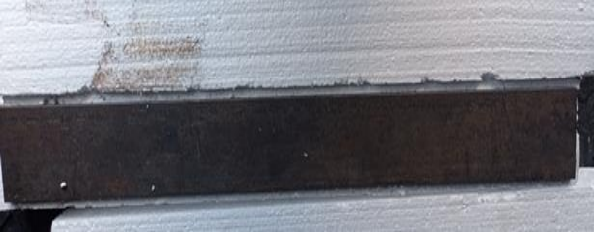
Şekil 4.1. Deneyde Kullanılan Alt Tabaka Malzemesi (AISI 1040)
