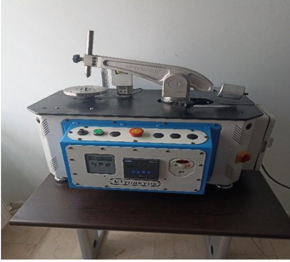
Şekil 4.16. Aşınma Cihazı ve Aşınma işleminin Şematik Gösterimi
