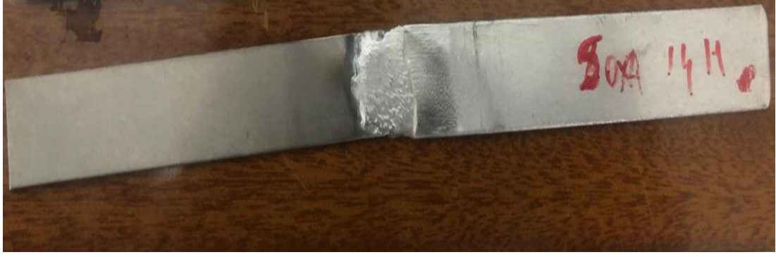
Şekil 3.15 Al 2024 ve GR2 malzemelerinin Al 2024 dolgu malzemesi ile TIG kaynağı ile birleştirilmesi sonucu elde edilen malzemenin görüntüsü
