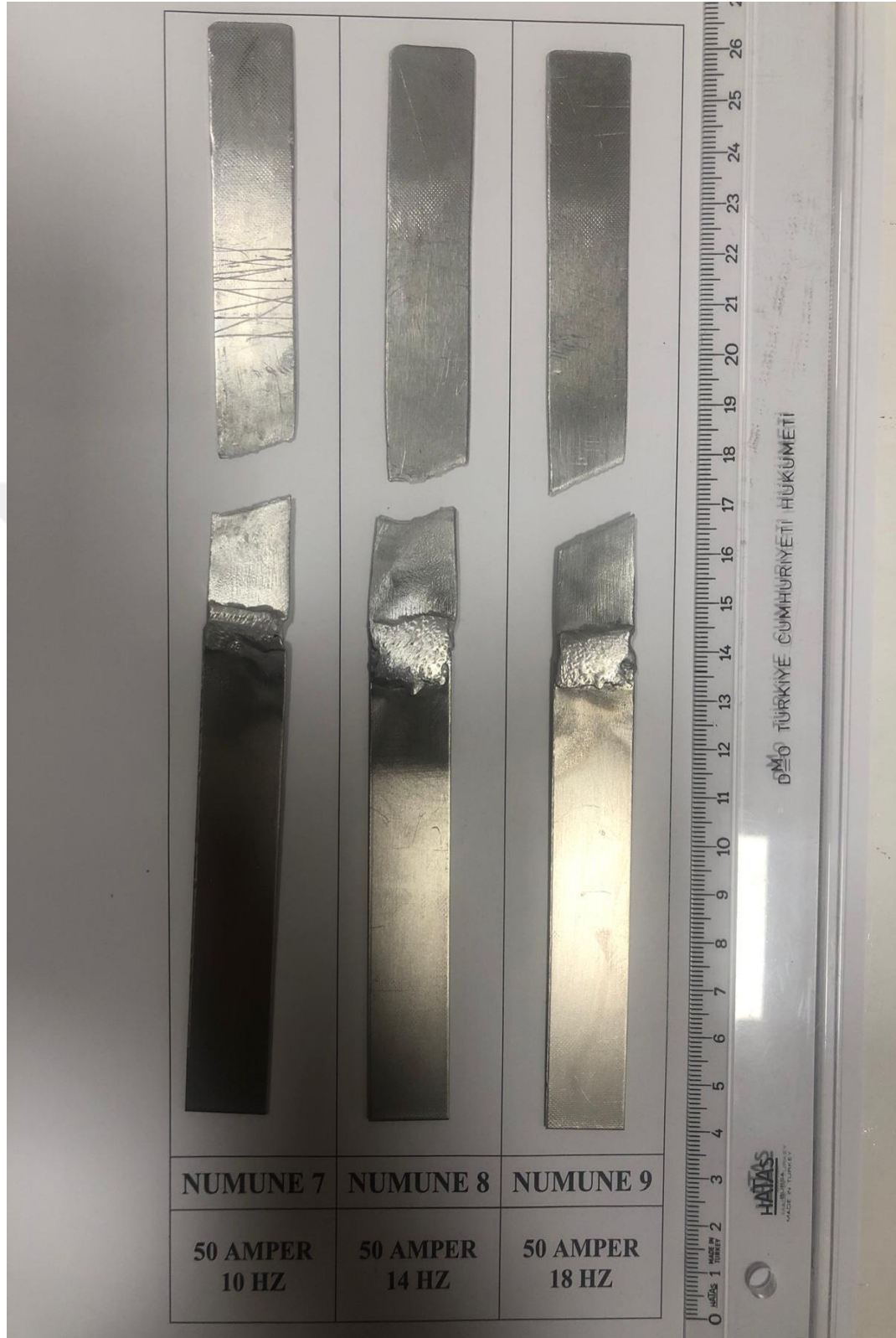
Şekil 5.14 50 Amper kaynak akımı uygulanmış ve sırasıyla 10, 14, 18 Hz pulse frekansı ile kaynaklanmış numunelerin çekme testi sonucu kopma görselleri
