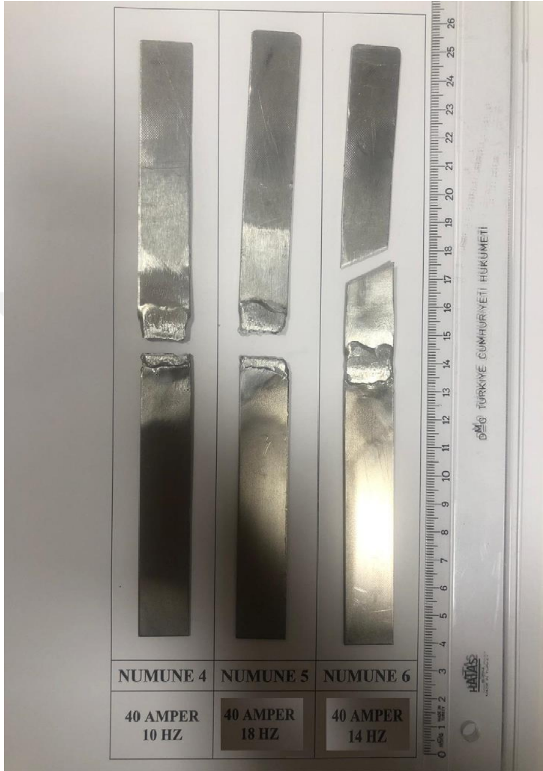
Şekil 5.13 40 Amper akım ve sırasıyla 10, 18, 14 Hz pulse frekansı ile kaynaklanmış numunelerin çekme testi sonucu kopma görselleri
