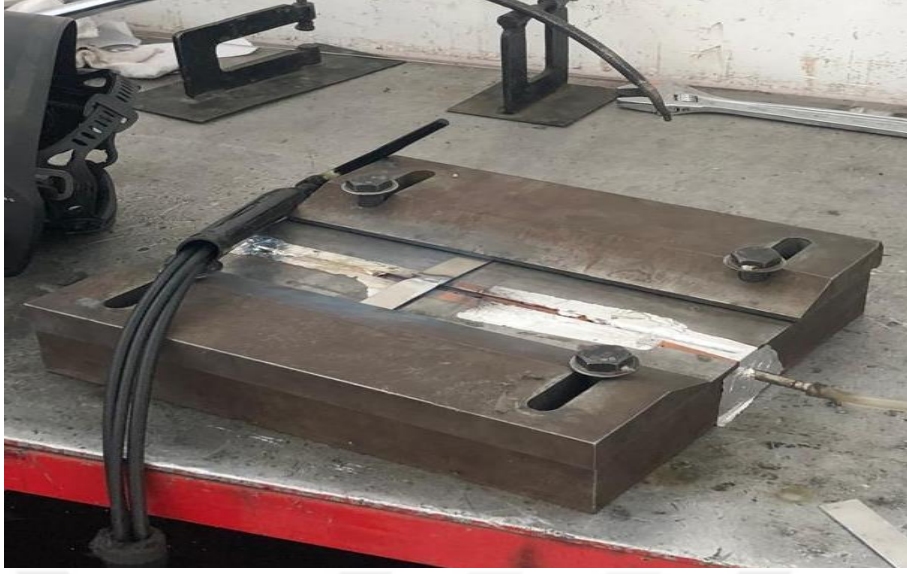
Şekil 4.3 Back-up, torc ve kaynak edilen malzemelerin görseli
