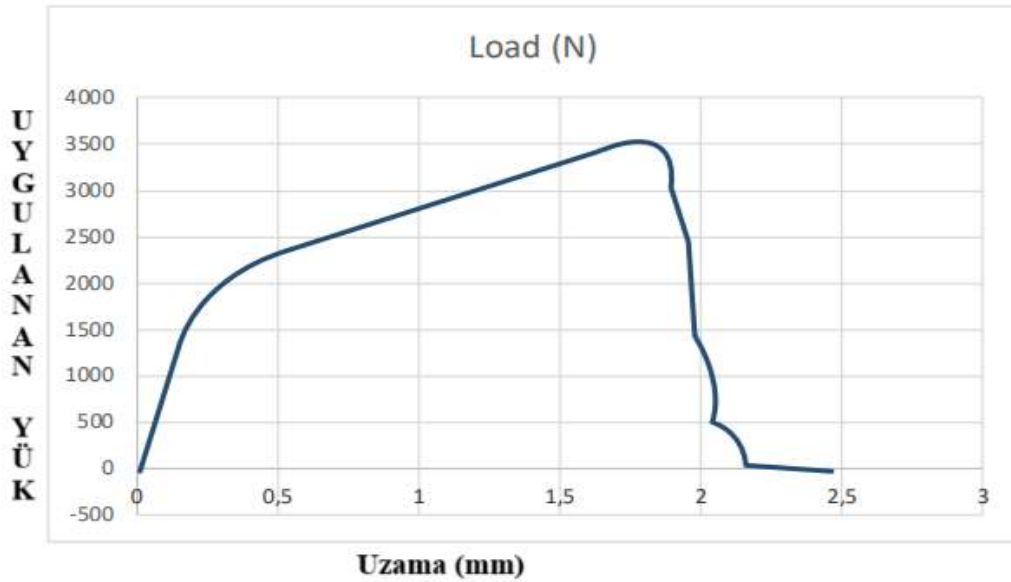
Şekil 5.16 30 Amper 14 Hz ile kaynatılan numunenin yük-uzama grafiği
