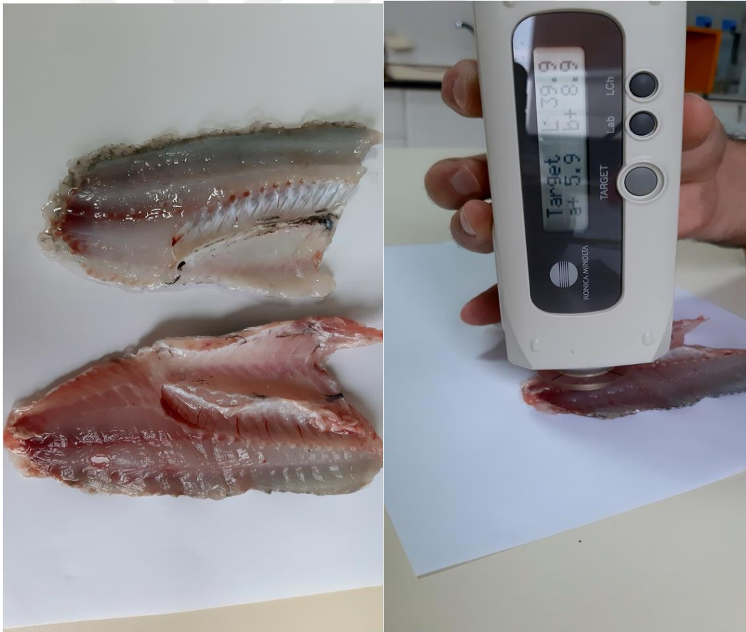
Şekil 10. Konica Minolta (CR 10, Japan) cihazı ile balık etinde renk ölçümü
