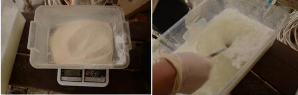
Şekil 5.32. Absorblayıcı Jel Oranlanıp Hazırlanması
