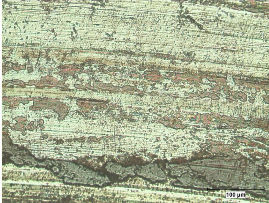
Şekil 5.12. Gaz Nitrürasyon İşlemi Yapılmış TiAlN Kaplanmış Toolox 44 Deney Numunelerinin 5 N Yük Altında Oluşan Aşınma Yüzeylerinin Optik Mikroskop Görüntüsü (200X)
