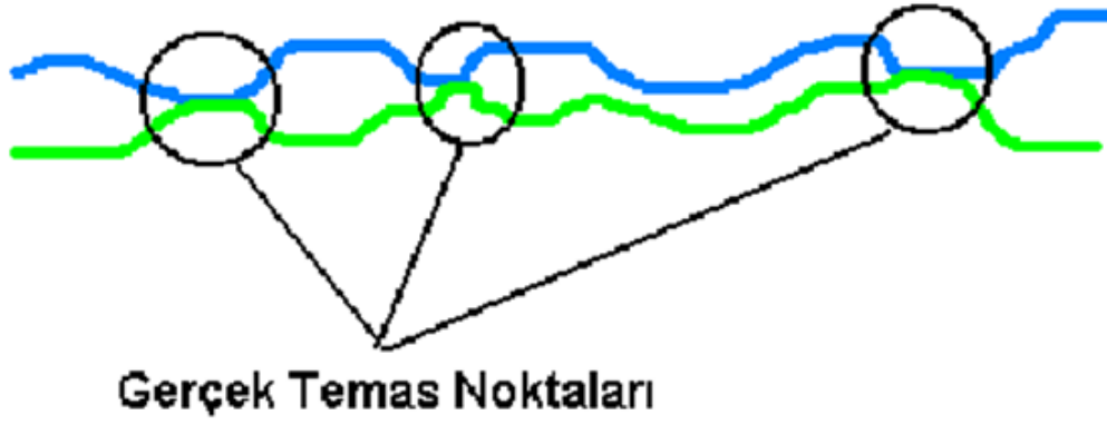
Şekil 2.2. Sürtünme Esnasındaki Gerçek Temas Noktaları [2,30].
