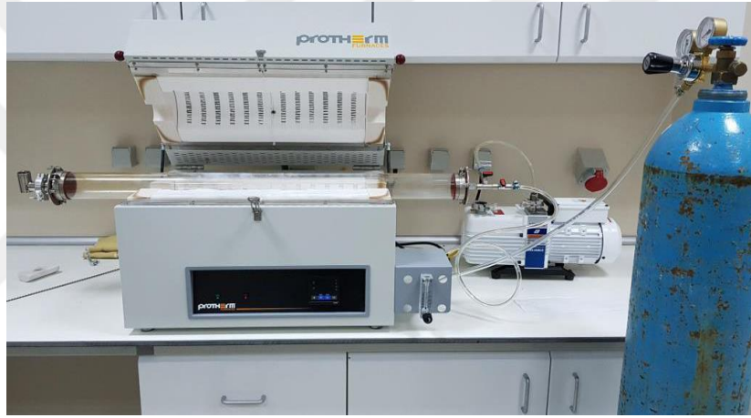
Şekil 3.17. Atmosfer kontrollü ısıtılma fırını
