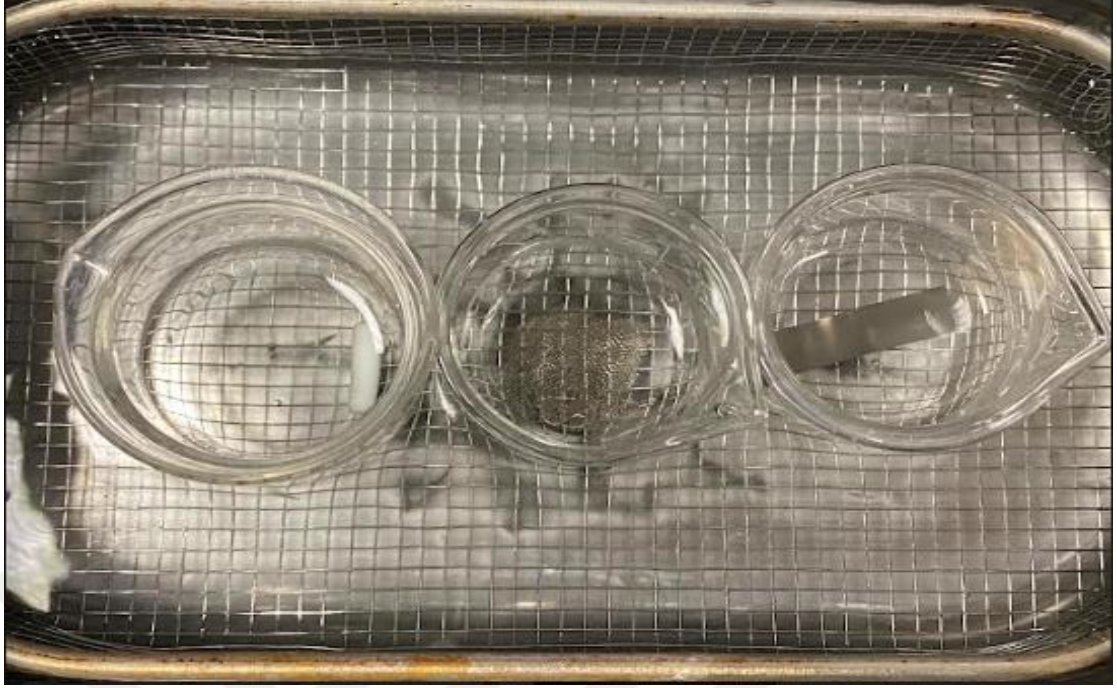
Şekil 4. 1. Kullanılan malzemelerin ultrasonik banyoda temizlenme süreci.
