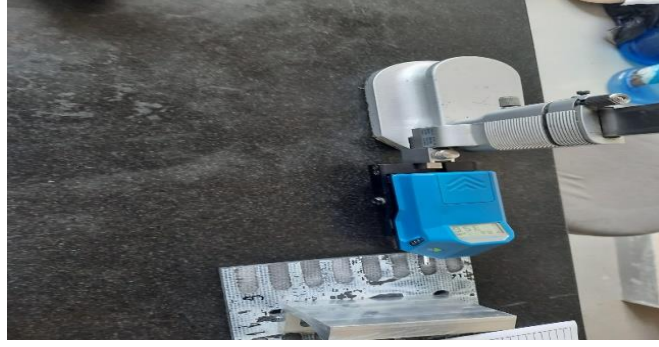
Şekil 4.12. Yüzey Pürüzlülük cihazı ve ölçümü
