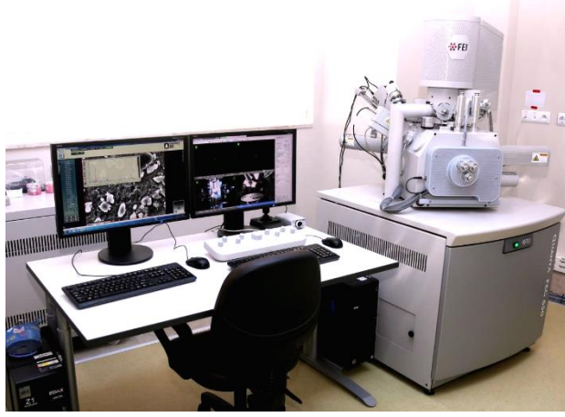
Şekil 4.14. Quanta 650 Field Emission SEM cihazı görüntüsü
