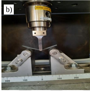
Şekil 4.6. a) Eğilme Cihazı, b) Cam Eğilme Numunesi, c) Karbon Eğilme Numunesi
