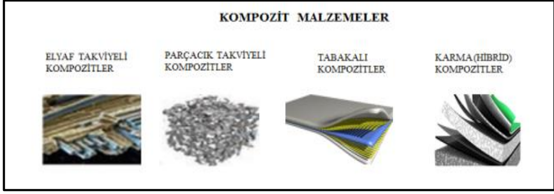
Şekil 3.5. Takviye Elemanlarına Göre Kompozit Malzemelerin Sınıflandırılması (Yastımoğlu ve Özkan, 2017)
