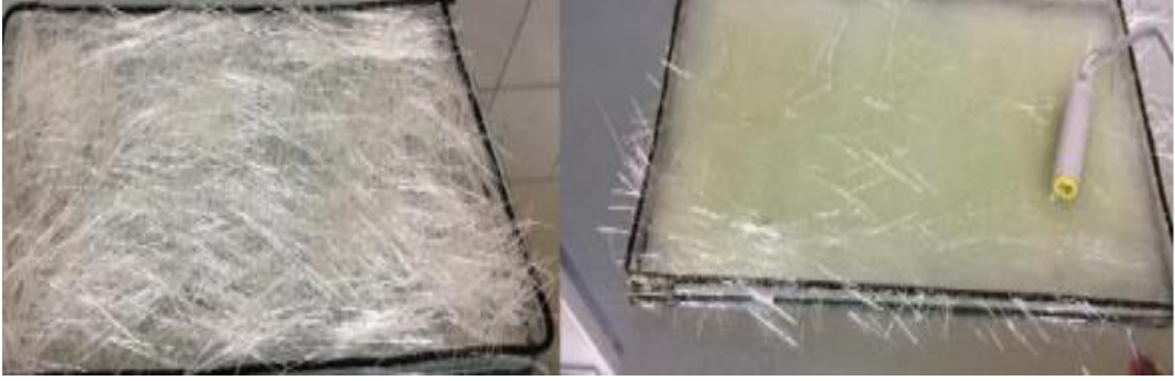
Şekil 3.12. Elyaf takviyeli polimer matrisli kompozit (Gökçe vd., 2020)
