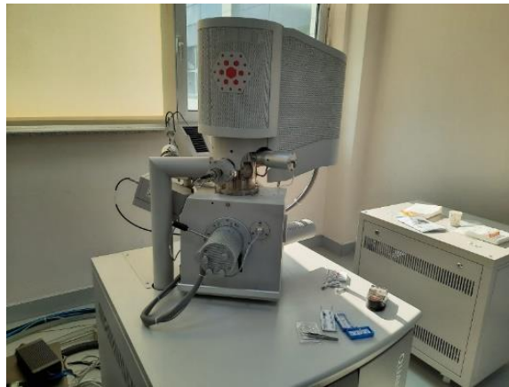
Şekil 4.13. Taramalı Elektron Mikroskop (SEM) cihazı görüntüsü
