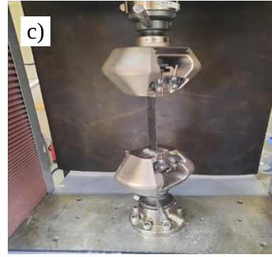
Şekil 4.4. a) Çekme Cihazı, b) Cam Çekme Numunesi , c) Karbon Çekme Numunesi
