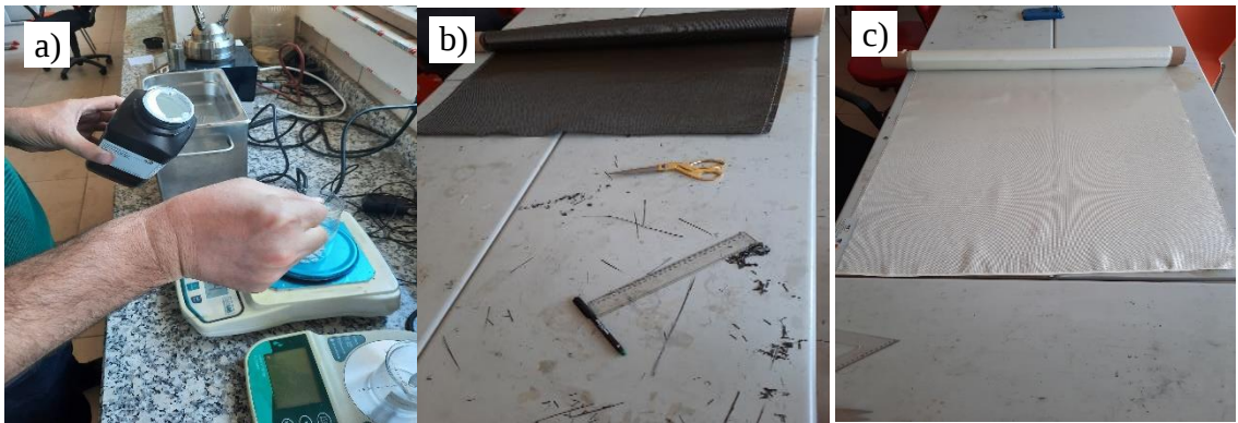
Şekil 4.1. a) \text{TiO}_2 dolgu parçacığı, b) karbon elyaf kumaş ve c) cam elyaf kumaş
