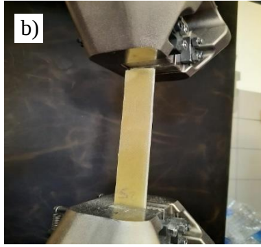
Şekil 4.4. a) Çekme Cihazı, b) Cam Çekme Numunesi , c) Karbon Çekme Numunesi
