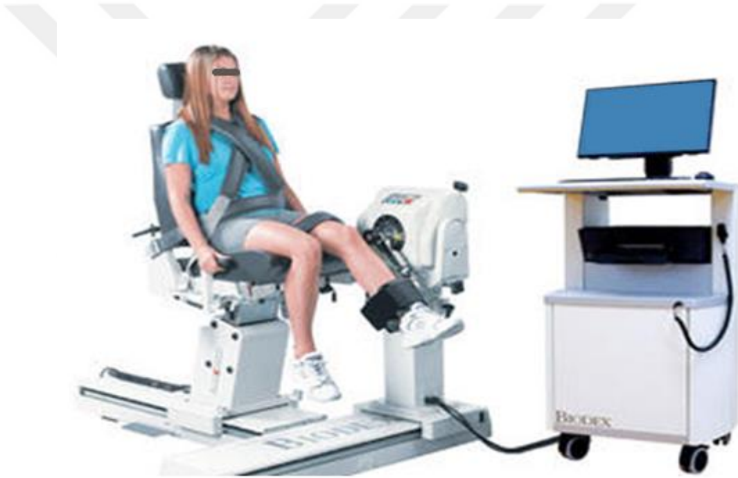
Resim 3. Diz için yapılan izokinetik ölçümlerdeki pozisyonlama
