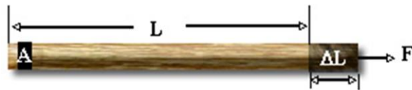
Şekil 2.5. Bir çubuğun kuvvet altında boyca uzaması
