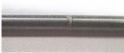
Şekil 3.4 Lazer kaynakla birleştirilmiş örnekler. Kaynak alanı; 1mm
