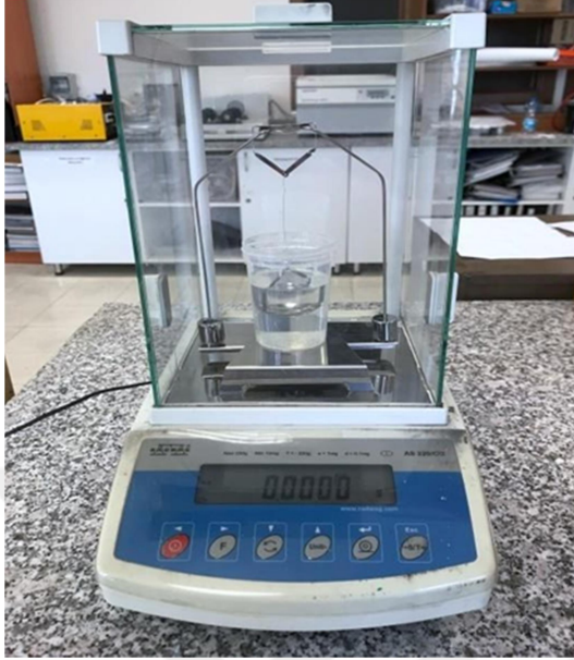
Şekil 3.9. Arşimet yöntemi ile yoğunluk ölçümü mekanizması
