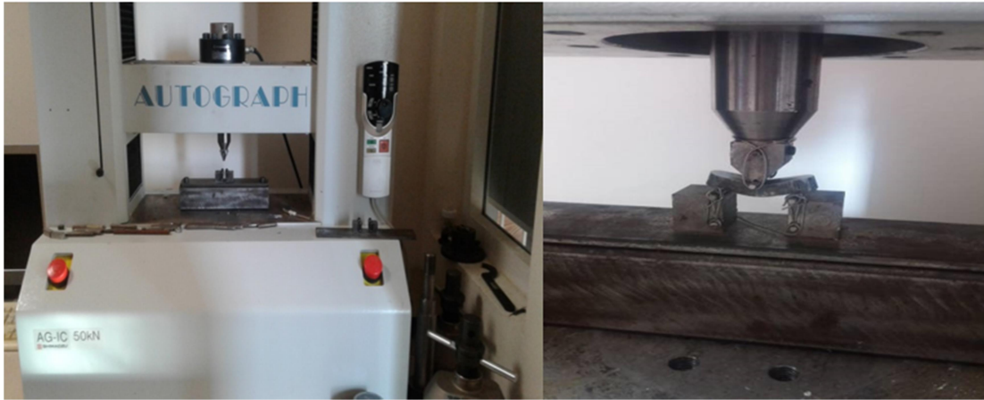
Şekil 3.10. Çekme-basma test cihazı ve uygulaması
