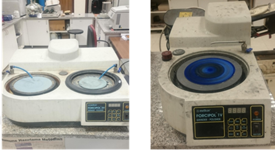
Şekil 3.12. Döner tablalı zımparalama ve parlatma makineleri
