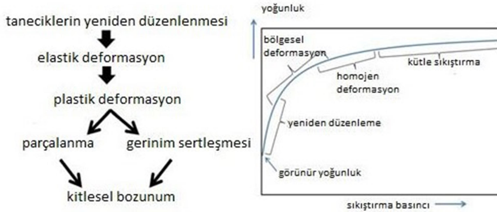
Şekil 2.4. (a) Temel aşamaları ve (b) toz sıkıştırma şemasını gösteren, metal tozu sıkıştırma sırasında sıkıştırma basıncına karşı yoğunluğun bir taslağı (German 1994)
