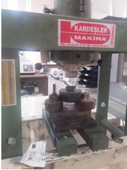
Şekil 3.6. Hidrolik preste numunenin kalıptan çıkarılması
