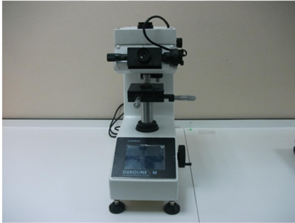
Şekil 3.11. Mikro-sertlik ölçüm cihazı
