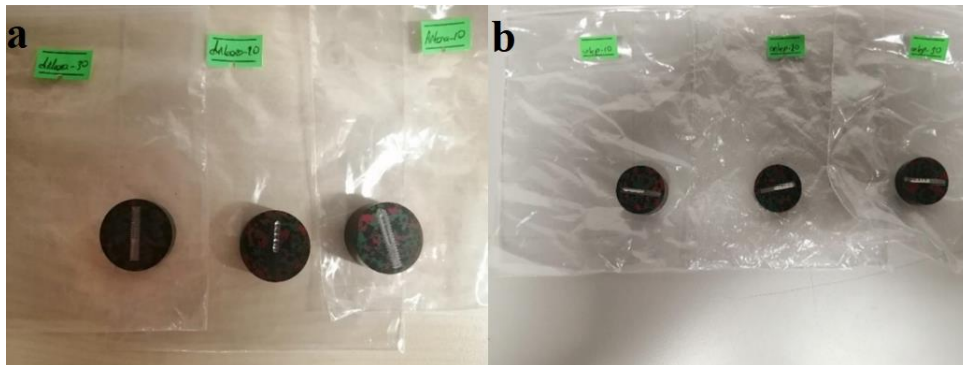
Şekil 3.3.4 (a) Ankara numunelerine sırasıyla 10N, 20N ve 30N yük uygulandıktan sonra aşınma test cihazından çıkan numunelerin görüntüleri (b) Gaziantep numunelerine sırasıyla 10N, 20N ve 30N yük uygulandıktan sonra aşınma test cihazından çıkan numunelerin görüntüleri
