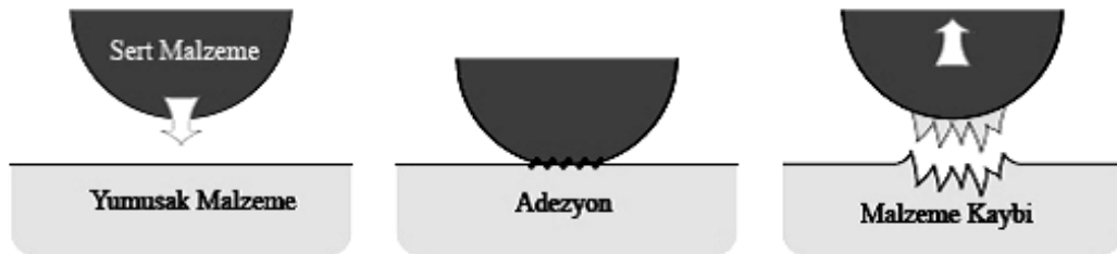
Şekil 1.4.1.1 Adezyon sırasındaki metal transferi [35]
