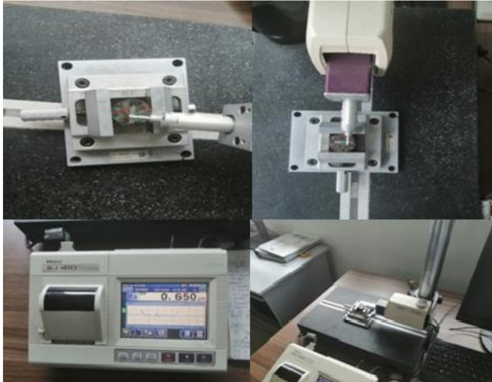
řekil 3.5.1 Ařınma iz derinliđi iin numunelerin cihaza yerleřtirilmesi
