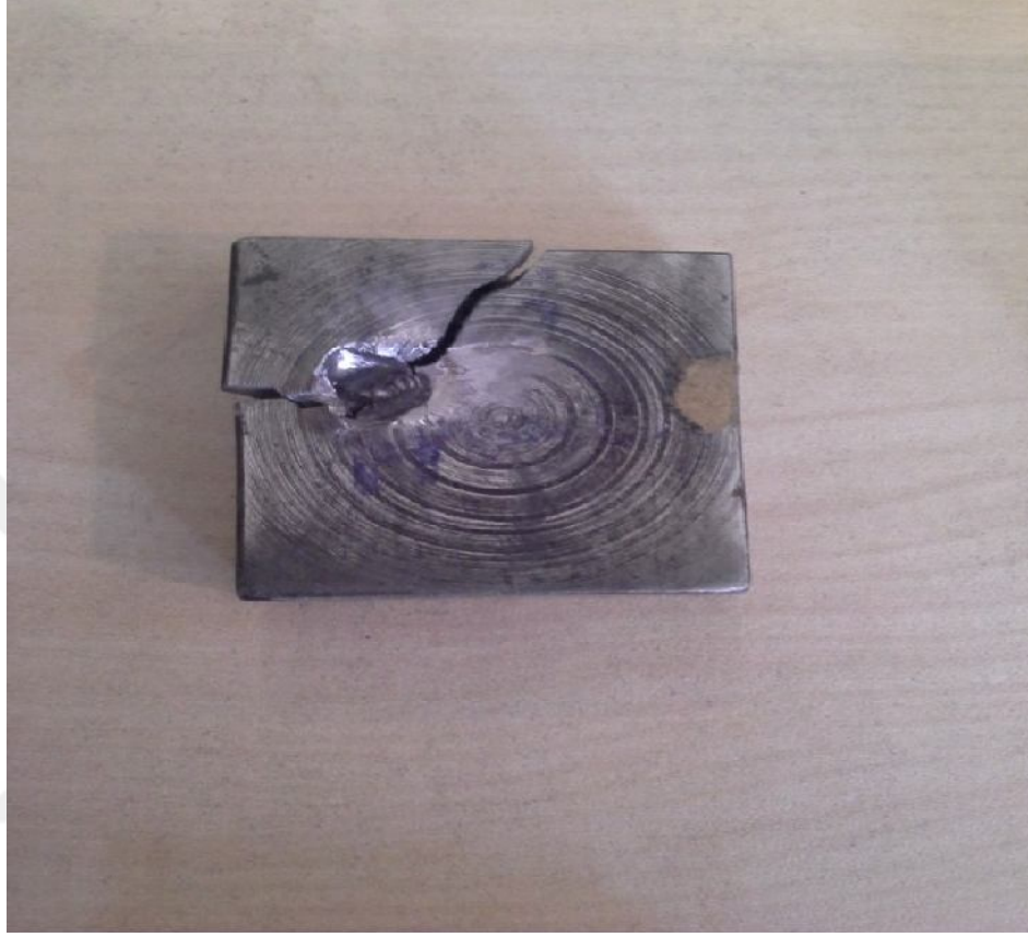
Şekil 7.5. 14 mm kalınlıkta İmalat Çeliğinin atış sonrası görüntüsü.
