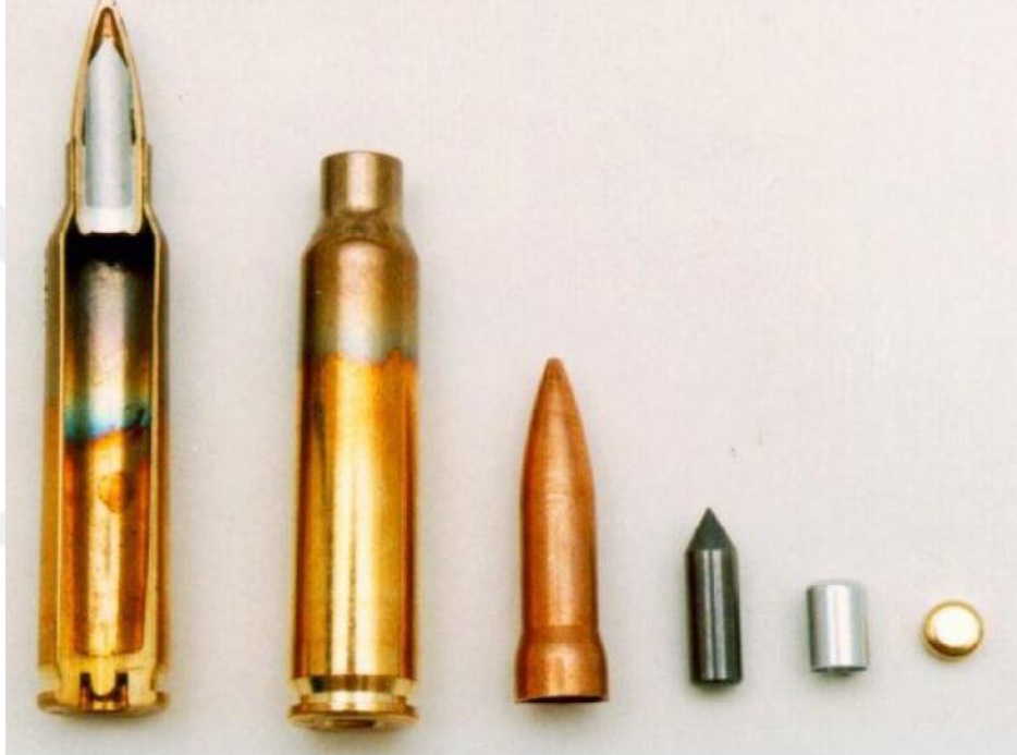
Şekil 6.3. 7.62 AP Mermisinin kesit Görüntüsü ve parçaları (Demir vd., 2008).
