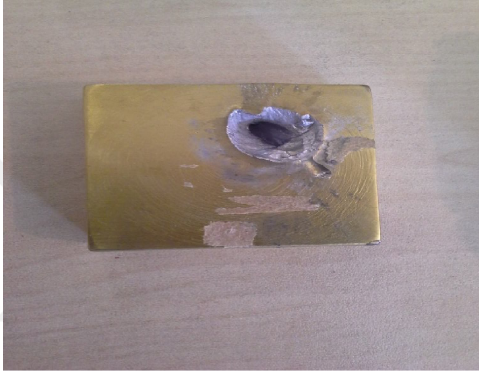
Şekil 7.6. 14 mm kalınlıkta Titanyum Kaplı İmalat Çeliğinin atış sonrası ön görüntüsü.
