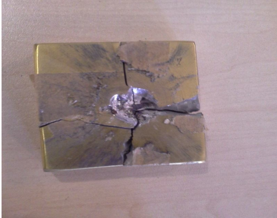
Şekil 7.11. 14 mm kalınlıktaki Titanyum Nitrit kaplı numunenin atış sonrası görüntüsü.
