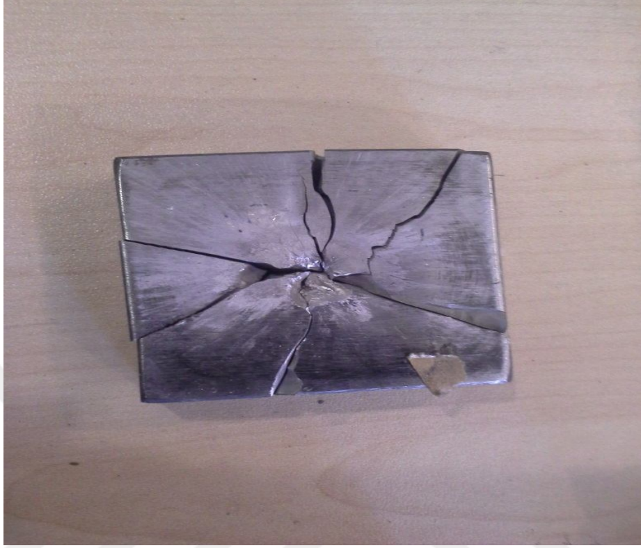
Şekil 7.10. 14 mm kalınlıktaki numunenin atış sonrası görüntüsü.
