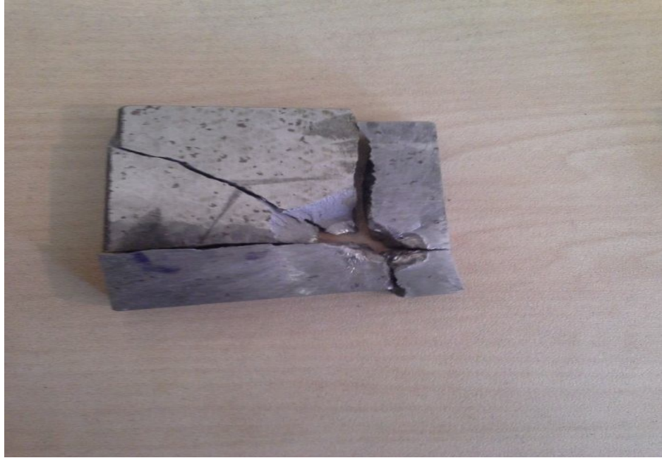
Şekil 7.2. 9 mm kalınlıkta İmalat Çeliğinin atış sonrası görüntüsü.
