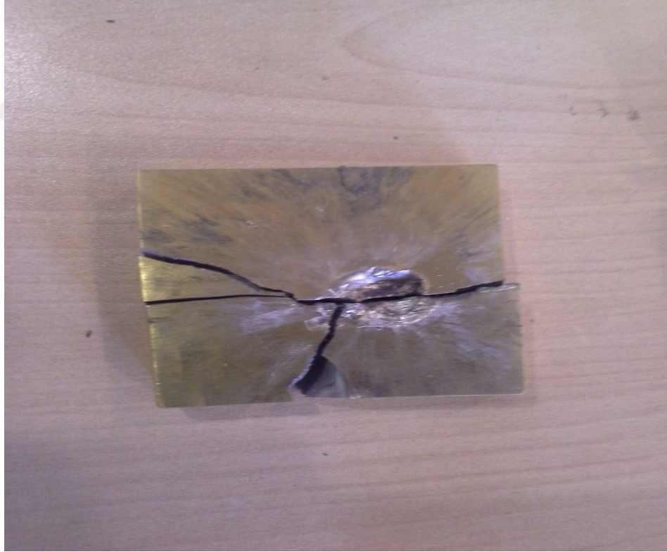
Şekil 7.9. 9 mm kalınlıkta Titanyum Kaplı numunenin atış sonrası görüntüsü.
