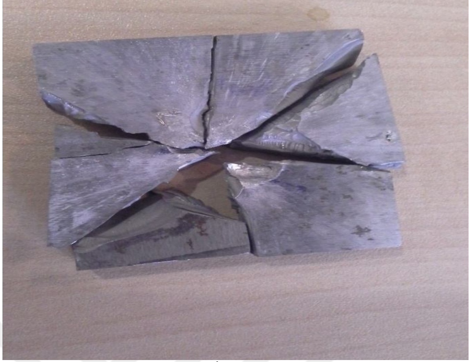
Şekil 7.8. 9 mm kalınlıkta Soğuk İş Takım Çeliğinin atış sonrası görüntüsü.
