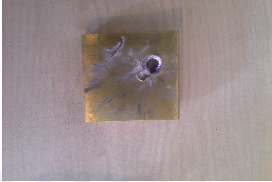
Şekil 7.3. 9 mm kalınlıkta Titanyum Nitrit Kaplı İmalat Çeliğinin atış sonrası ön görüntüsü.
