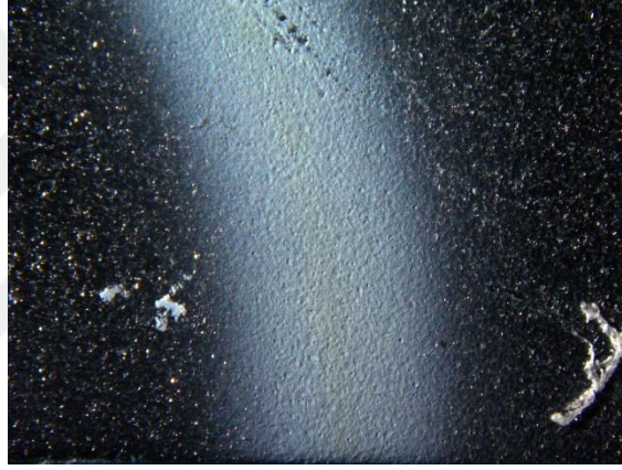
Şekil 6.13. HAP-b ile kumlanmış Titanyum plaka üzerine 7 mm mesafeden yapışan kaplama sonrası çekilen 11x büyütmede optik mikroskop görüntüsü ( 15000 \text{ cm}^3/\text{dak} gaz akış hızı)
