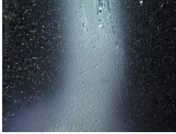
Şekil 6.12. HAP-b ile kumlanmamış Titanyum plaka üzerine 7 mm mesafeden yapışan kaplama sonrası çekilen 11x büyütmede çekilen optik mikroskop görüntüsü ( 15000 \text{ cm}^3/\text{dak} gaz akış hızı)
