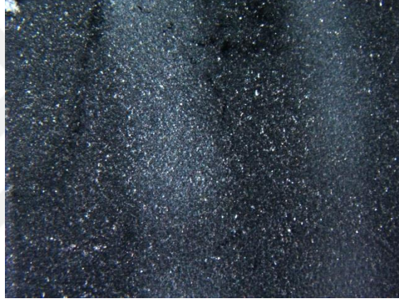
Şekil 6.19. HAP-k HAP ile kumlanmış Titanyum plaka üzerine 3 mm mesafeden yapılan kaplama sonrası 11x büyütmede çekilen optik mikroskop görüntüsü (15000 cm 3 /dak gaz akış hızı)
