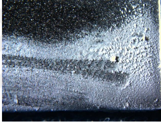
Şekil 6.16. HAP-s ile kumlanmamış Titanyum plaka üzerine 3 mm mesafeden yapılan kaplama sonrası 11x büyütmede çekilen optik mikroskop görüntüsü (15000 cm 3 /dak gaz akış hızı)
