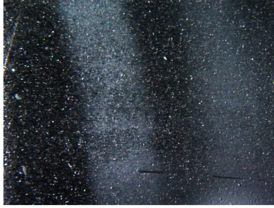
Şekil 6.18. HAP-k ile kumlanmış Titanyum plaka üzerine 3 mm mesafeden yapılan kaplama sonrası çekilen 11x büyütmede optik mikroskop görüntüsü (15000 cm 3 /dak gaz akış hızı)
