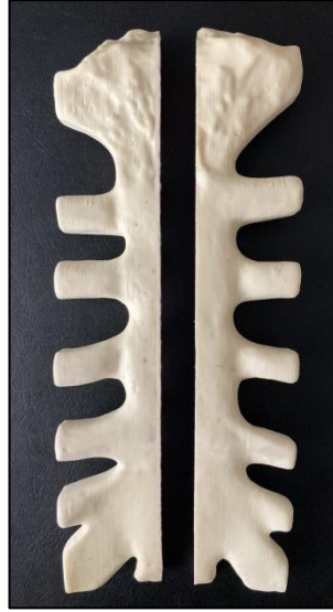
Şekil 3.1. Mediyen sternotomi prosedürü uygulanan poliüretan sternum modeli
