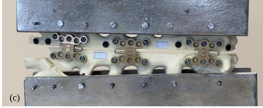
Şekil 4.1. Üç titanyum plâk yöntemi deneylerindeki farklı göçme mekanizmaları
