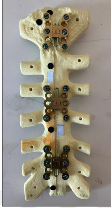
Şekil 3.3. Üç tane X-şekilli titanyum plâk kullanılarak sternumun sabitlenmesi
