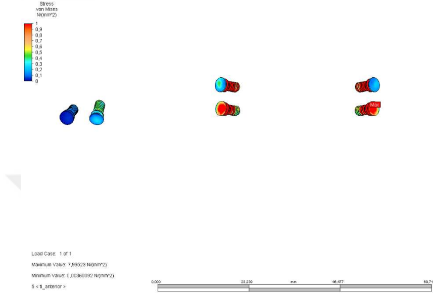
Şekil 4.27. Model 1'deki anterior dik açılı kuvvetlere karşı titanyum fiksasyon vidaları üzerinde oluşan Von Mises Stresler
