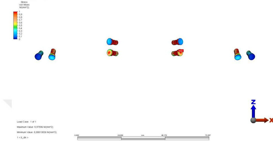
Şekil 4.3. Model 1’deki posterior dik kuvvetlere karşı titanyum fiksasyon vidaları üzerinde oluşan Von Mises Stresler
