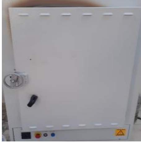
Şekil 3. 5. Sinterleme fırınının iç ve dış görünümü
