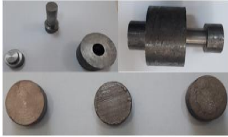
Şekil 3. 4. Soğuk presleme esnasında kullanılan kalıp ve preslenen numuneler
