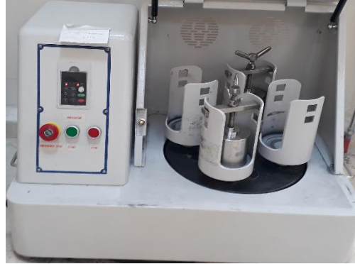
Şekil 3. 2. Mekanik alaşımlama cihazının görünümü
