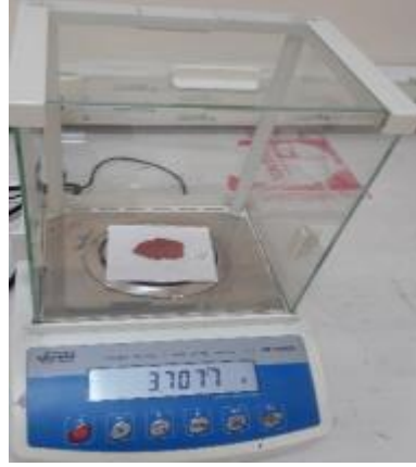
Şekil 3. 1. Elementlerin tartması esnasında kullanılan hassas terazi
