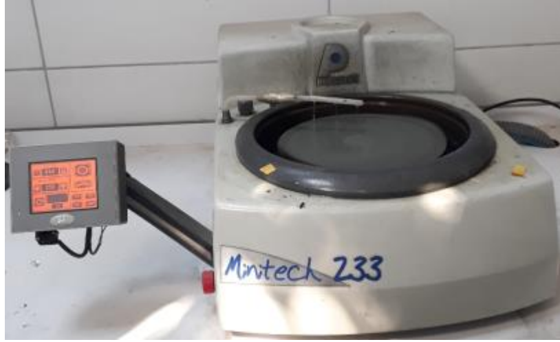
Şekil 3. 7. Parlatma ve zımparalama cihazı
