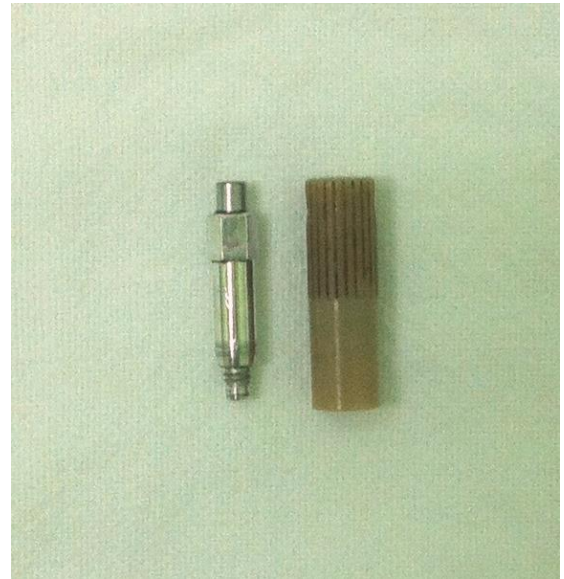
Şekil 3.4. Smartpeg ve özel plastik taşıyıcı
