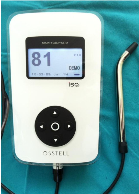
Şekil 3.3. Osstell ISQ cihazı
