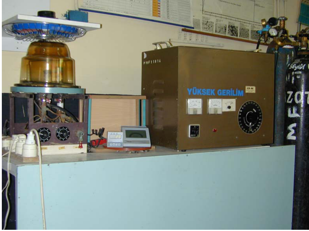
Şekil 4.1 Plazma nitürleme deney düzeneği
