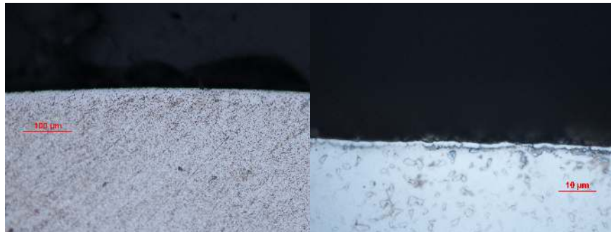
Şekil 5.1 700, 800, 900 ve 1000 °C'de çeşitli işlem sürelerinde plazma nitrürlenmiş Ti6Al4V alaşımının yüzeyinde oluşan tabakaların resimleri
