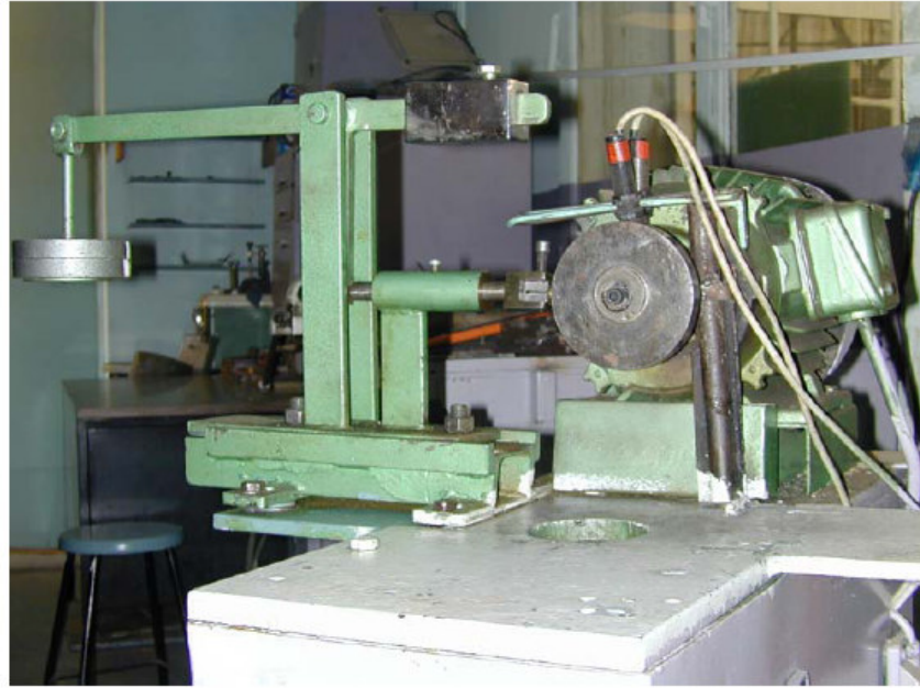
Şekil 4.2 Aşınma deneyinde kullanılan test cihazı
