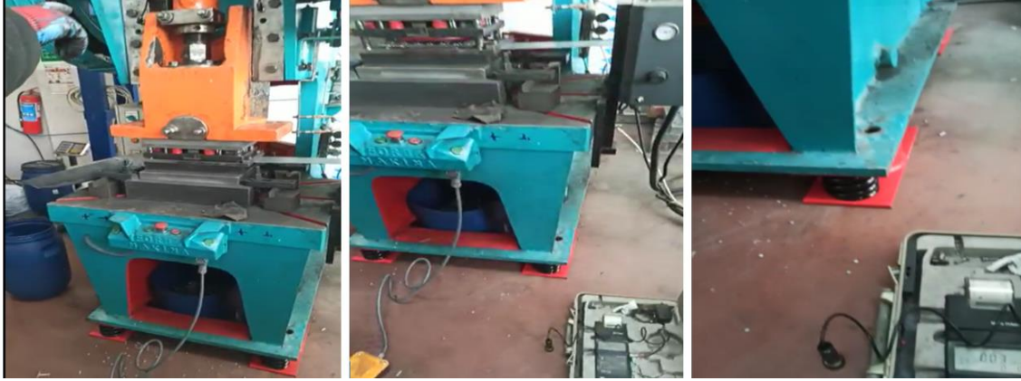
Resim 3.4 Yaylı titreşim takozu uygulaması.
