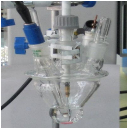
Şekil 4.1. (a) Çalışmada kullanılan Potentiostat-Galvonastat cihazı (b) Deneylerde kullanılan üç elektrotlu sistem (c) Kullanılan elektrotlar sırasıyla; çalışma, referans, karşıt elektrodu
