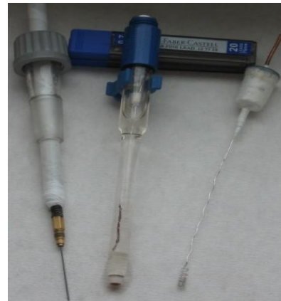
Şekil 4.1. (a) Çalışmada kullanılan Potentiostat-Galvonastat cihazı (b) Deneylerde kullanılan üç elektrotlu sistem (c) Kullanılan elektrotlar sırasıyla; çalışma, referans, karşıt elektrodu
